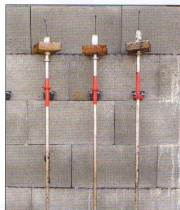
Monitorování kompostovacího procesu (systém kontroly teploty COMPOtemp) – zapichovací teploměr Compost Systems GmbH. Tři měřicí místa v rozsahu měření 0–120 °C
