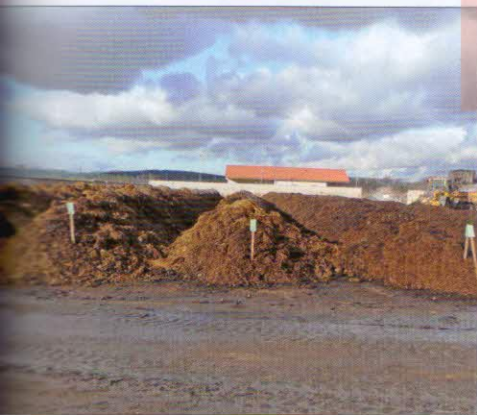
Kompostovací plocha – Compost Systems GmbH (Rakousko). Nově vybudovaná vodohospodářsky zajištěná betonová plocha, do které jsou zabudovány provzdušňovací kanály (COMPOair), se svodem do záchytné jímky. Kompostovací plocha – velikost 7400 m 2 , z toho 3200 m 2 provzdušňováno – (80 x 40) m, objem jímky – 384 m 3
