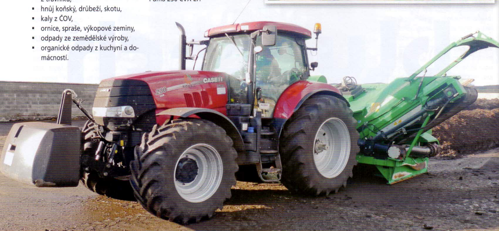
Energetický prostředek – kolový traktor Case IH Puma 230 CVX EP s výkonem motoru 198 kW
