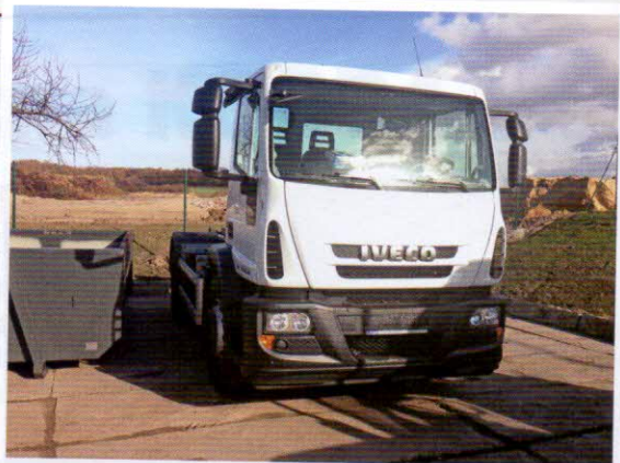
Svoz surovin – nákladní kontejnerové vozidlo IVECO Eurocargo ML 190EL25 s výkonem motoru 185 kW. Ve výbavě nosič kontejnerů TNH12/42
