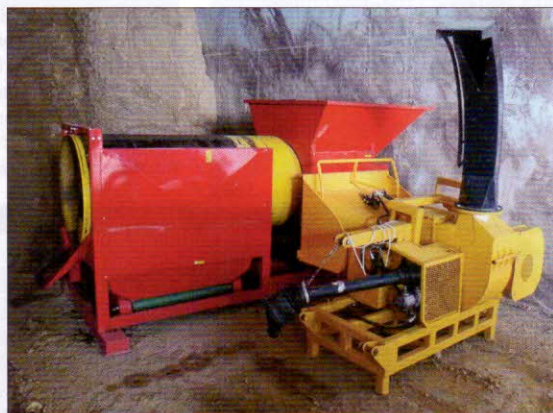
Prosévání kompostu – bubnová prosévačka substrátu NOVER BPS-02 s elektromotorem 2,95 kW. Velikost oka síta 20 x 20 mm, výkonnost zhruba 15 až 25 m 3 /h
