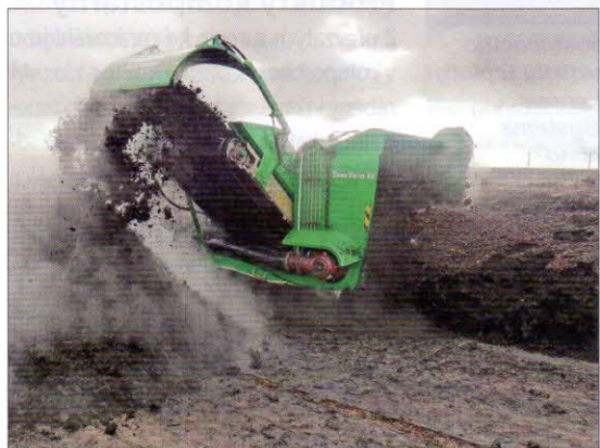
Překopávání kompostu – přípojitelný překopávač kompostu Compost Systems TracTurn IV pracuje v agregaci s traktorem. Pracovní prostor 3,7 x 2,3 m, výkonnost 1000–2000 m 3 /h
