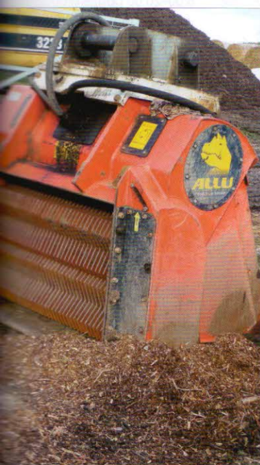
Prosévání a homogenizace surovin – třídicí a drtící lopata IDEACHIP Oy (Finsko) ALLU SML 2-12 s požadovaným příkonem 20 kW a výkonem 3–6 m 3 /h
