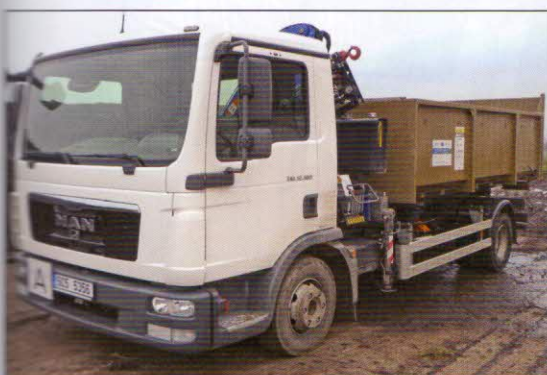
Scoz surovin – nákladní automobil MAN TGL 12.180 s výkonem motoru 132 kW a nosností 11,99 t je vybaven nástavbou pro kontejnery a hydraulickým jeřábem s drapákem (objem 0,75 m 3 ). Ocelové kontejnery HCS CENTRUM (16 kusů má objem 9 m 3 , jeden kontejner má objem 17 m 3 , tři kontejnery s objemem 26 m 3 )
