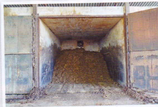
Technologie kompostování - soustava deseti fermentačních komor AGRONOM CS. Fermentační komora s půdorysem 5 x 7 x 4 m a objemem 140 m 3 (hmotnost vsázky asi 80 t)
