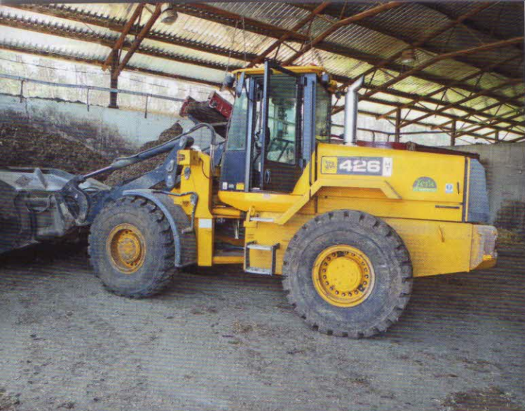
Manipulace se surovinami – kolový nakladač JCB 426 HT s výkonem motoru 113 kW a lopatou o objemu 2,5 m 3
