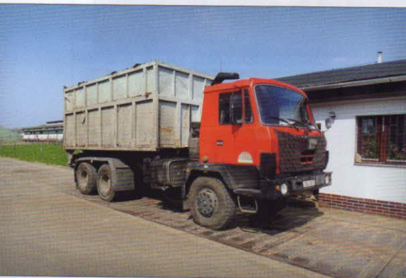
Doprava zpracovávaných surovin a kompostu – tři nákladní automobily TATRA 815 s nosiči kontejnerů
