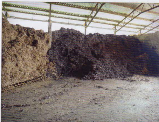
Příjem a skladování zpracovávaných surovin – skladová hala s vodohospodářsky zajištěnou plochou rozdělená do pěti boxů o velikosti 1 x 1000 t, 2 x 500 t, 2 x 600 t. Kapacita uskladňovaného množství je max. 2000 t
