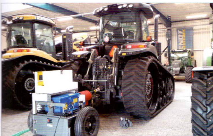
Obr. 3 – Traktor Challenger MT775E s připojenou výkonovou brzdou AW NEB 400
