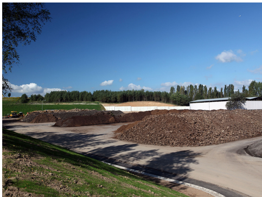
Obr. 2: Kompostování v pásových hromadách
