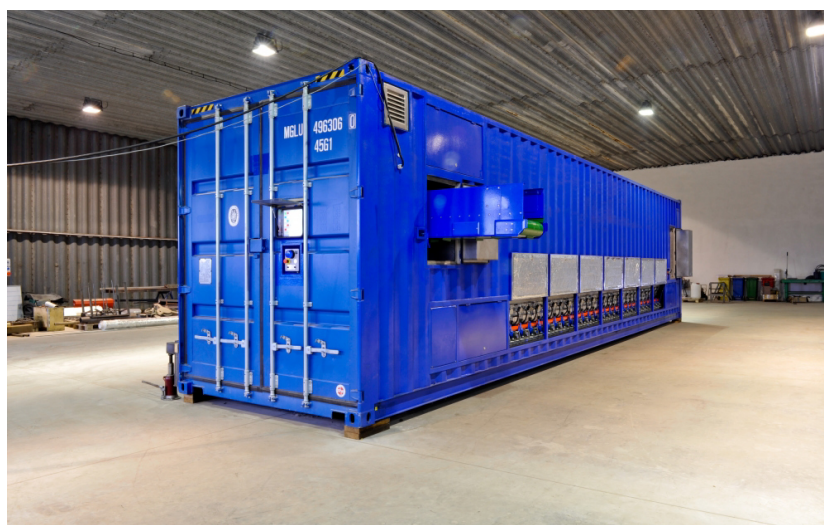
Obr. 7: Aerobní fermentor EWA, výrobce AGRO-EKO
