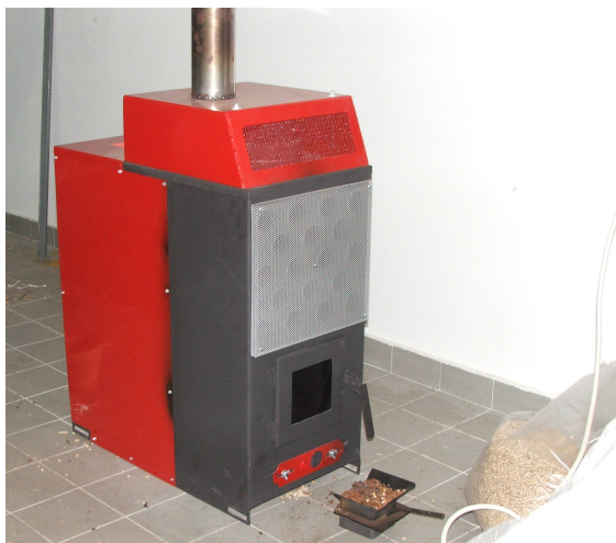
Obr. 14: Horkovzdušná kamna na pelety KNP KOVO NOVÁK - zkoušky peletované nadsítné štěpky z kompostovacího procesu a peletované směsi kompost + smrkové piliny v poměru 1 : 1
