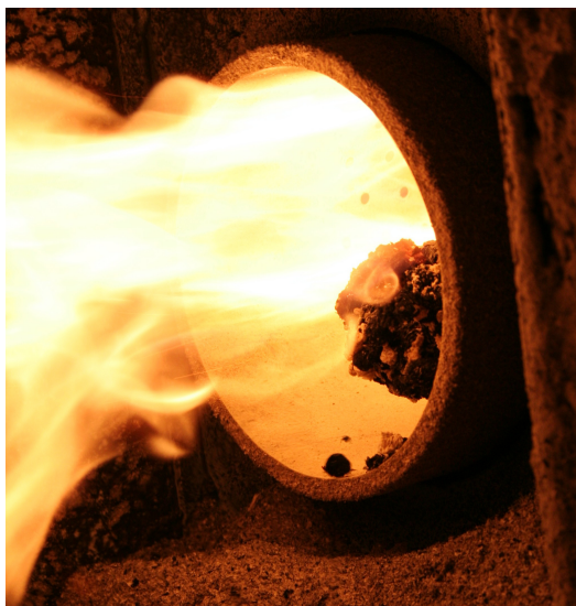
Obr. 15: Teplovodní kotel EKOEFEKT PETRO 49 s rotačním hořákem PETROJET A70 - zkoušky peletovaného vysušeného separátu z BPS
