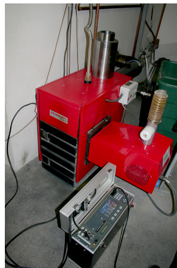
Obr. 15: Teplovodní kotel EKOEFEKT PETRO 49 s rotačním hořákem PETROJET A70 - zkoušky peletovaného vysušeného separátu z BPS
