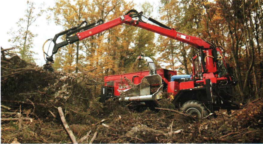
Obrázek 10: Samojízdný štěpkovač (výkon motoru 300 kW)
