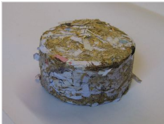
Obr. 4: Směsné briquety luční seno papír 70 % / 30 %
