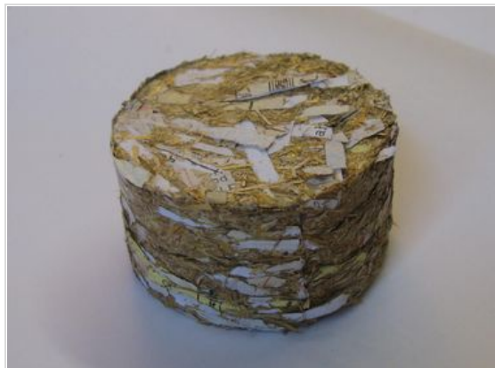
Obr. 3: Směsné briquety luční seno papír 80 % / 20 %
