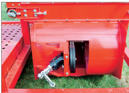
31 Detail provedení vzduchového separačního a odhliňovacího zařízení
