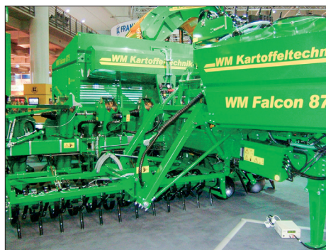
19 Osmiřádkový kombinovaný sázeč brambor s rotačním kypřičem a formovačem hrůbků
