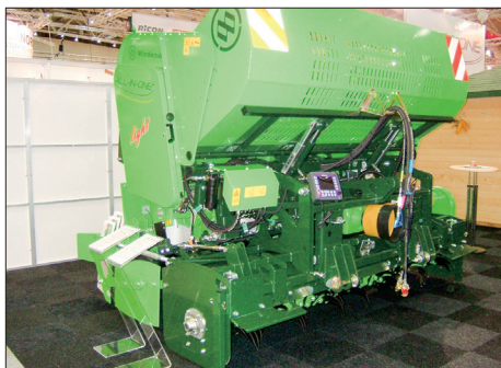
7 Spojování strojů na přípravu půdy, sázení a úpravu hrůbků do jediné stroje je současným trendem ve vývoji techniky
