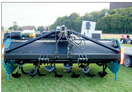
12 Rotační hloubkový kypřič s horizontální osou rotace
