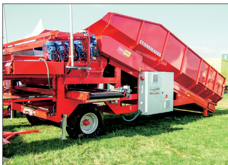
44 Mobilní přestavitelná příjmová, třídící, naskladňovací i vyskladňovací zařízení
