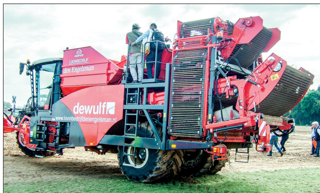
35 Samojízdný čtyřřádkový sklízeč Ploeger je vybaven drtičem natě, přebíracím a třídícím zařízením a řídicí senzorem technikou
