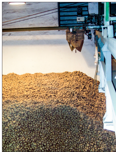
37 Koncová část vrstvicího dopravníku vybavená kaskádami (pevnými nebo automatickými) v každé sekci skladovacího boxu u
