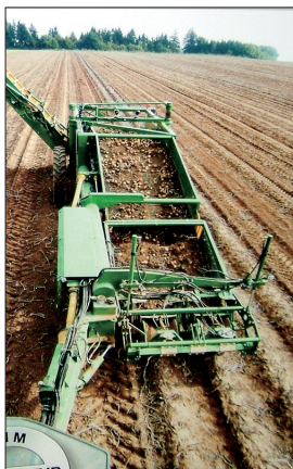
34 Nové vyorávací nakladače mají variabilně boční nebo osově vyorávání s řídicím systémem Can Bus
