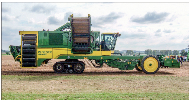
35 Samojízdný čtyřřádkový sklízeč Ploeger je vybaven drtičem natě, přebíracím a třídícím zařízením a řídicí senzorem technikou
