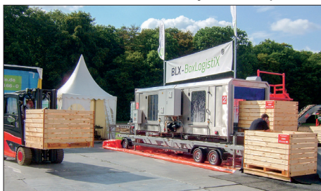
41 Na mytí a desinfekci skladovacích palet jsou vyvinuty nové automatické mobilní systémy
