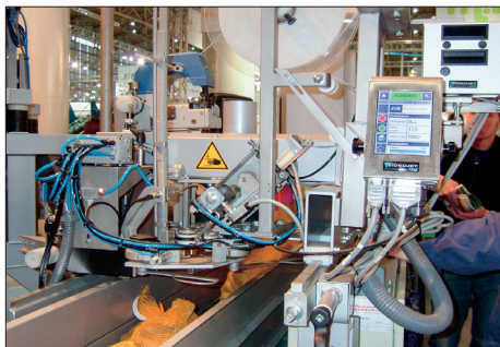
49 Automatické baličky na síťové úplety nebo rašlové a PE sáčky
