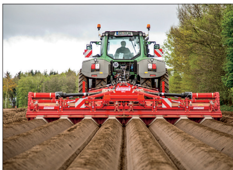
14 Osmiřádková rotační půdní fréza pro přípravu půdy a úpravu hrůbků před sázením
