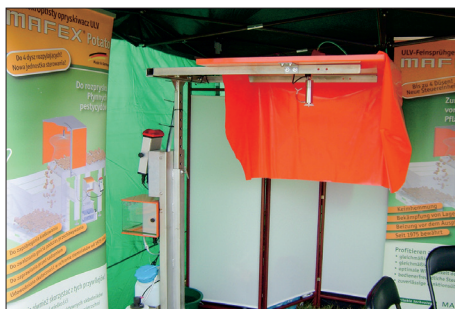
45 Zařízení na aplikaci tekutých přípravků na ochranu proti skládkovým chorobám
