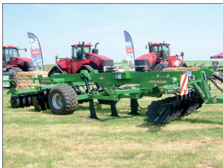
3 Nové kombinace podryvačů a talířových podmiťáčů lze pro jarní přípravu půdy využít
