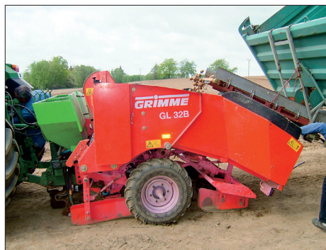
22 Pro dopravu volně ložené sadby a plnění sázeče je převážně používán dopravní prostředek s vyprazdňovacím dopravníkem
