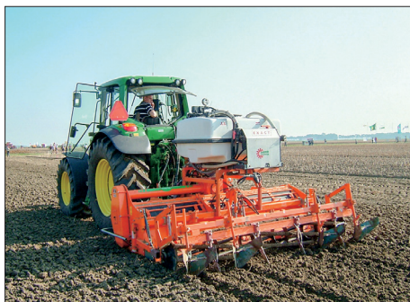
8 Rotační kypřič na přípravu půdy s aplikátorem kapalných hnojiv a zařízením na vyznačení řádků řízený satelitní navigací
