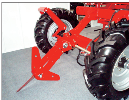
21 Protierozní zařízení na sázeči vytváří hrázky zabraňující odtoku dešťové vody
