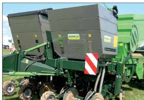
16 Sázeče jsou nově vybavovány zařízením pro přihnojování organickými hnojivy
