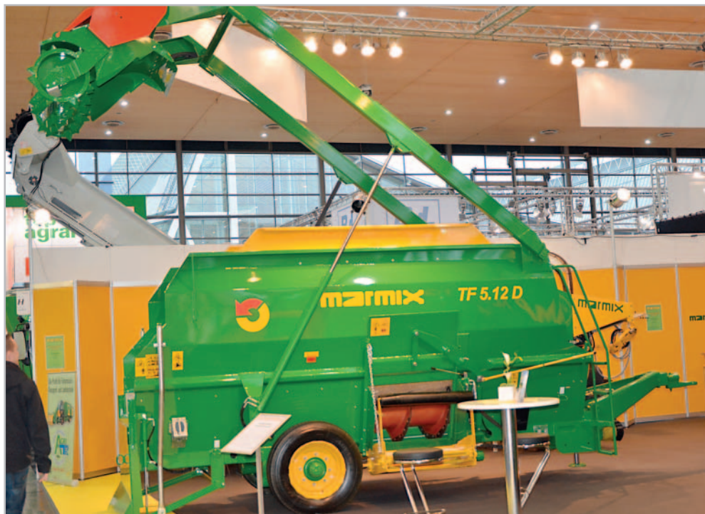
Mobilní míchací krmný návěs s detailem na vyběrací frézu a vyzprázdňovacím zařízením
