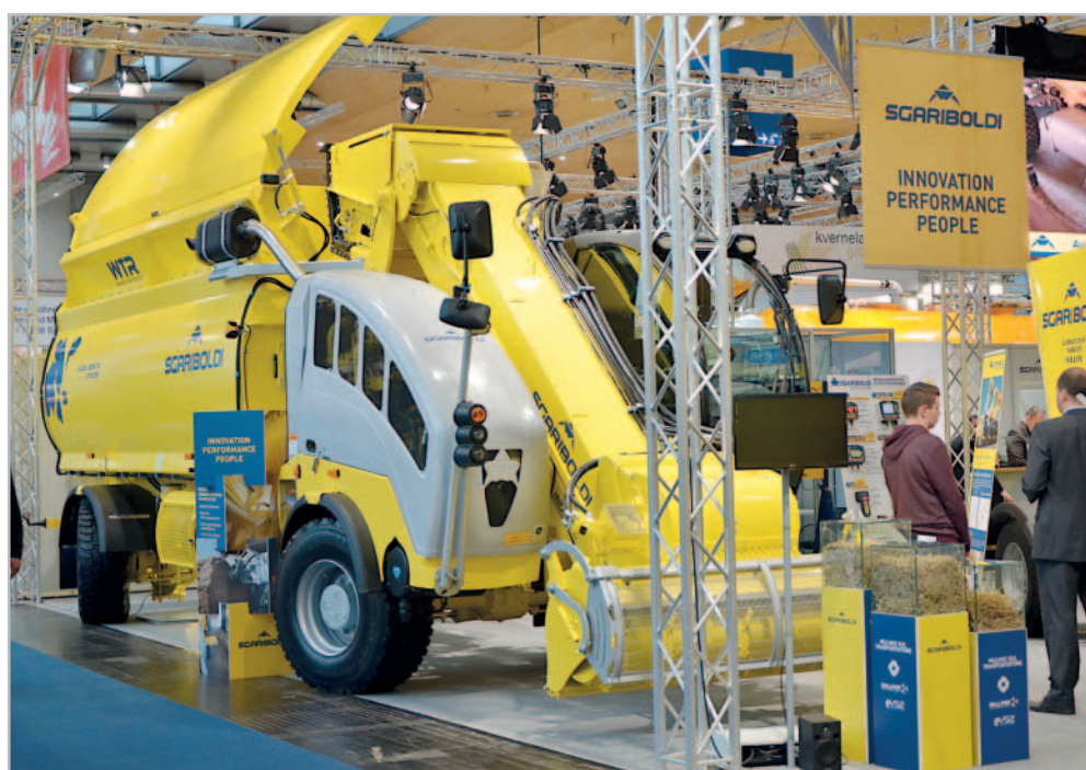
Samojízdný míchací krmný vůz vybavený čelně neseným nakládacím ústrojím
