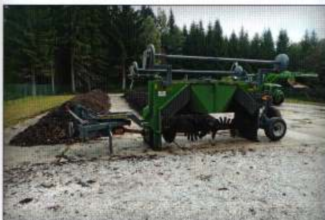
Překopávání kompostu – překopávač kompostu Morawetz US 3000 s pracovním prostorem (š x v) 3000 x 800 mm. Speciálním vybavením je sklopení pro transport a adaptér pro svinování kompostovací plachty
