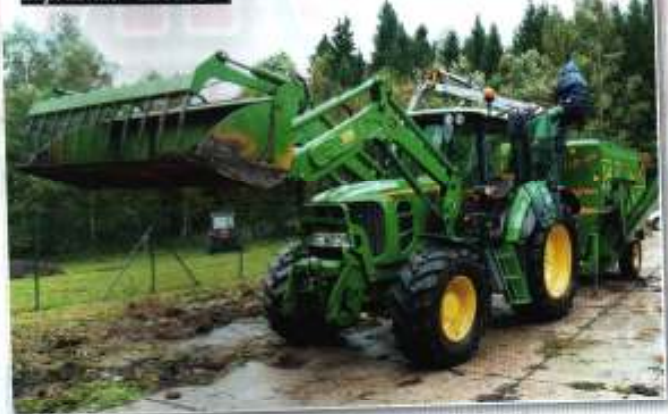
Manipulace se surovinami - adaptér ke kolovému traktoru - H 340 s čelní nakládací blůci s objemem 1,1 m 3 . Adaptér k drticí biomasy - otočný nakládací jeřáb - délka 4,3 m a výnosceť lopravník - délka 3 m
