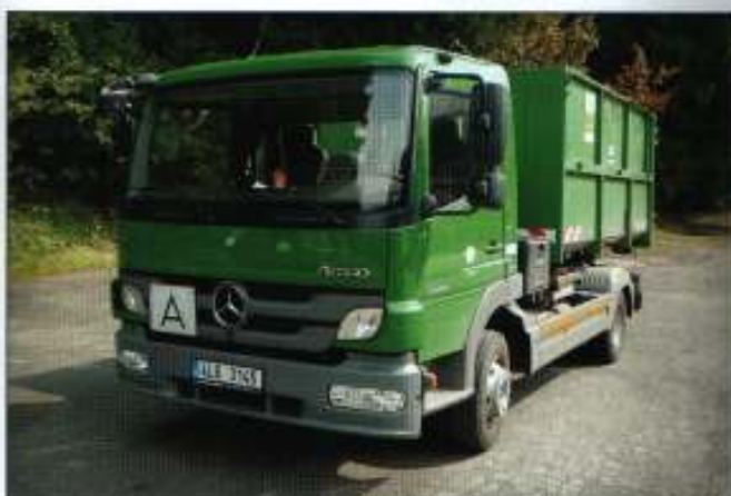
Svoz surovin – nosič kontejnerů včetně jednoramenného teleskopického nosiče kontejnerů Mercedes-Benz Atego 1022 a nosič CTS PRO 06-33-S
