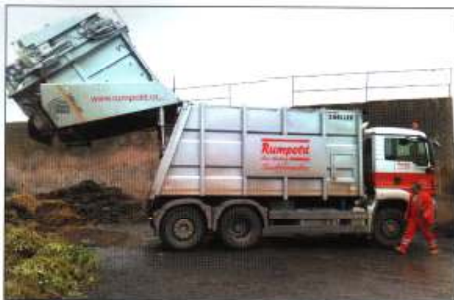
Dovoz BRKO vozidlem MAN TGS, firmy RUMPOLD UHB, s. r. o. – automobil s nástavbou pro výsyp nádob, 21 m 3
