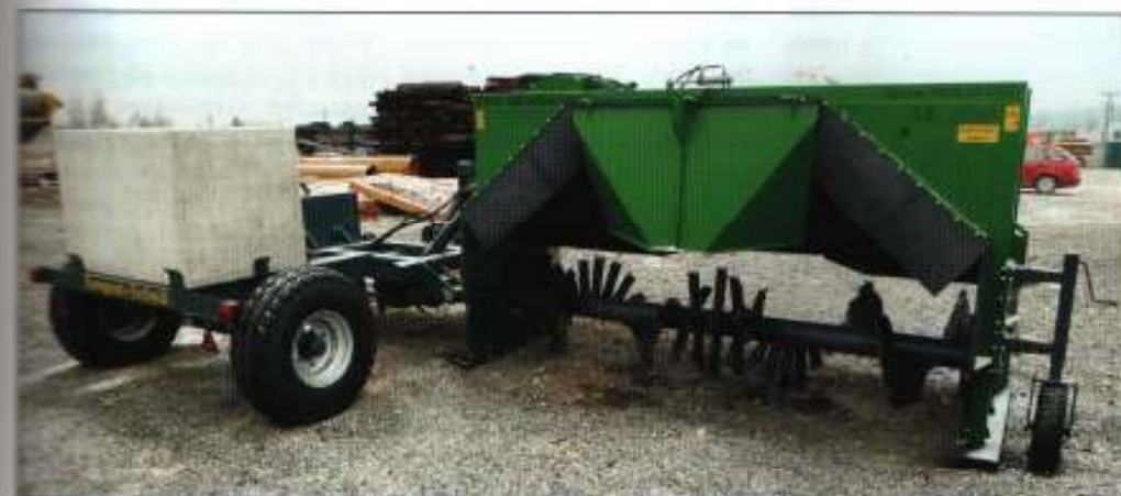
Překopávání kompostu - překopávač kompostu Moravetz AK 3000 s pracovním prostorem (6 x v) 3000 x 800 mm je agregován s traktorem
