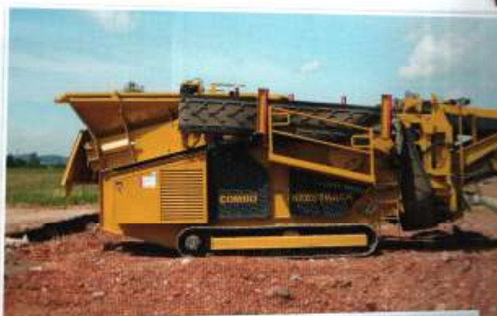
Prosevaní kompostu - síťový třídící Keestrack combi s dieselovým motorem 50 kW pracuje s výkonností až 100 t/h a s velikostí ok síta 65/65, 33/30, 25/25 mm
