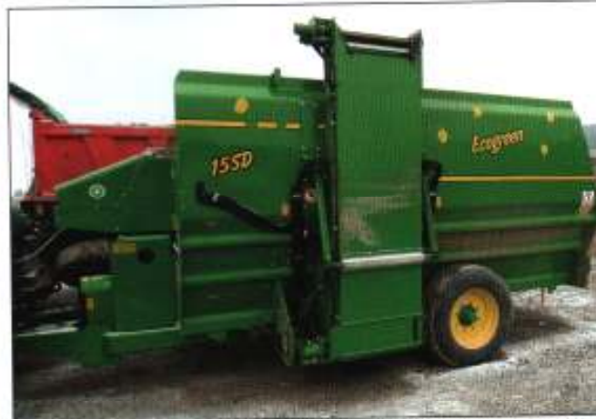
Promíchávání a homogenizace surovin – drtič biomasy Ecogreen – Zago 15SD GRU
