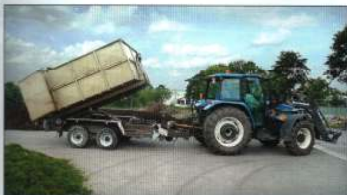
Svoz surovin – kolový traktor s taženým nosičem kontejnerů NAVARA. Nosič sedlí (nosnost 7 t), ocelový kontejner NAVARA (5 ks) s objemem 11 m 3
