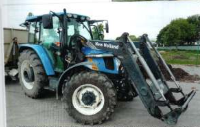
Energetický prostředek a manipulace se surovinami – kolový traktor New Holland T500 s čelní lopatou New Holland, typ 740TL
