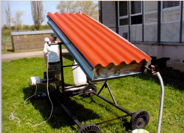
Obr. 3 – Měření prostupu tepla vláknocementovým střešním panelem
