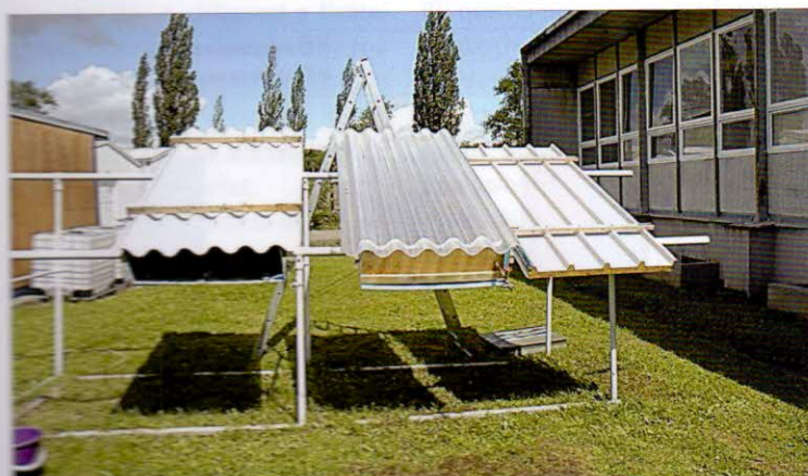
Obr.4 – Testované střešní panely (vláknocementový, prosvětlovací a tepelně izolovaný)
