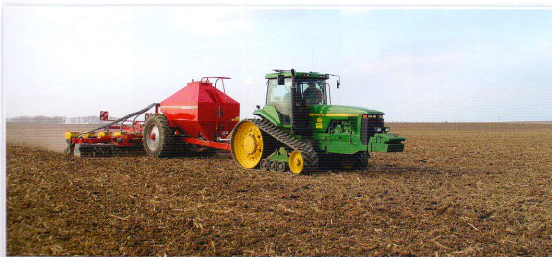
V technologiích zakládání porostů obilnin bez orby sečí stroj osivo rozprostírá v pruzích pod proud podříznuté zeminy radličkami, stroj pracuje s vysokou výkonností
