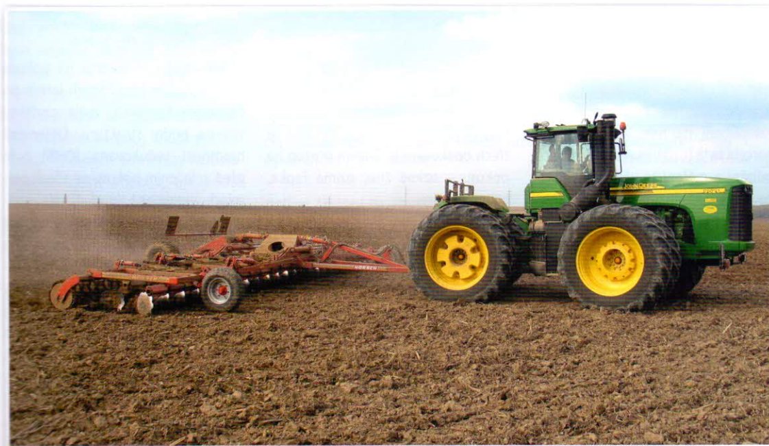
Talířové podmičáče mají vysokou výkonnost a dobře do povrchové vrstvy ornice zapraví i vrstvu posklizňových zbytků
