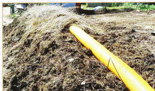
Kompostovací zakládka ve formě pásové hromady pro výzkum využitelnosti odpadního tepla v průběhu kompostovacího procesu Foto Petr Plíva
