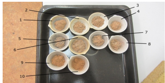
Obr. 3. Vzorky konopí biomasy po vyjmutí z muflové pece
