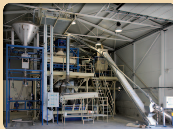
Linka na čištění máku, POEX Velké Meziříčí, a.s.
