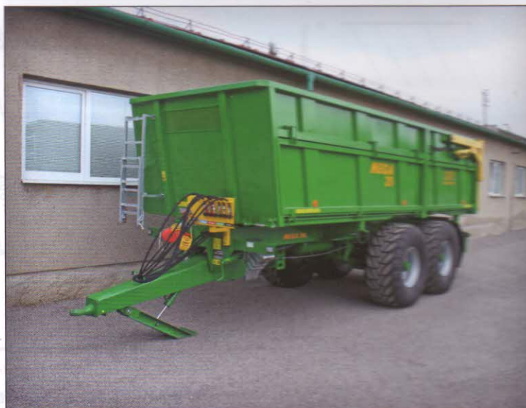
Obr. 9 – Volba typu pneumatik návěsu má zásadní vliv na utužení půdy
