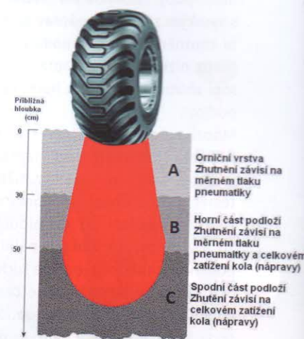
Obr. 2 – Vliv měrného tlaku pneumatiky a celkového zatížení kola na zhutnění v profilu půdy
