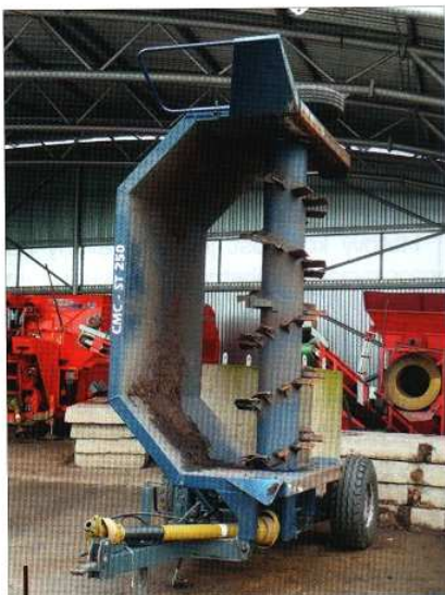
prekopávanie kompostu - ľaháný prekopávač kompostu CMC ST 250 Compost Systém GmbH (Rakúsko) s pracovným priestorom 2,5 x 1,3 m zvládne spracovať 500 m 3 za hodinu
