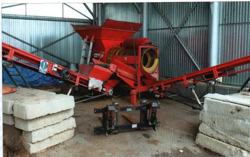
Prebierka kompostu - triedenie substrátu Nextra (ČR) s elektrickým motorom s výkonom 2,95 kW a výkonnosťou 15 až 25 m 3 /h
