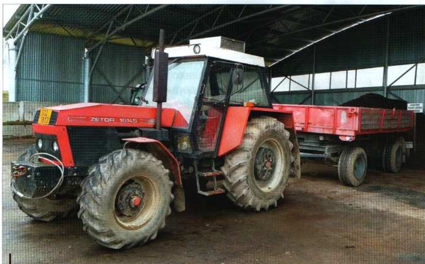
Energetický prostriedok - starší kolesový traktor ZETOR 16145 s menovitým výkonom 95 kW. Manipulácia so surovinami je riešená čelným kolesovým nakladačom Caterpillar 908 s objemom lopaty 1 m 3
