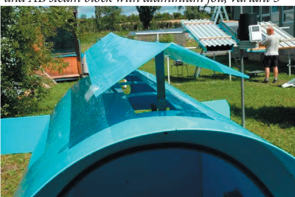
Obr. 4: VIB se stříškou zvednutou o 190 mm nad střešní pláň VIB a se 4 střešními větracími otvory o rozměrech 250x110 mm, varianta 4
