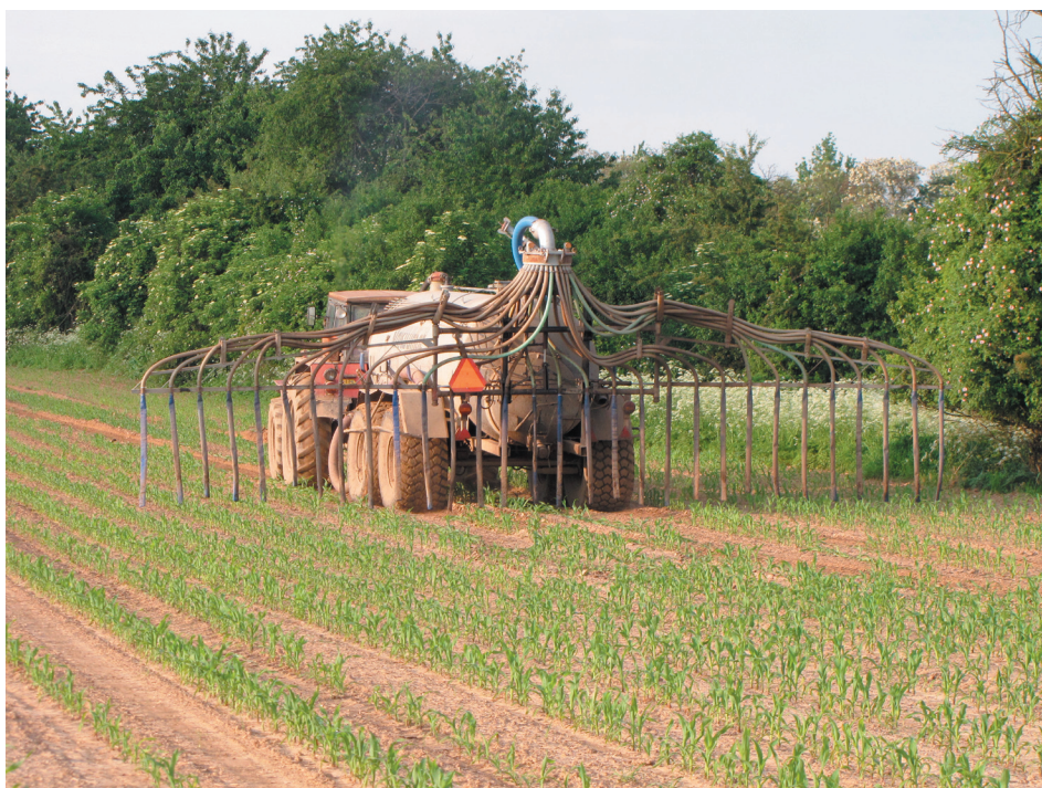
Obr. 1: Hadicový aplikátor s instalovaným GPS modulem
