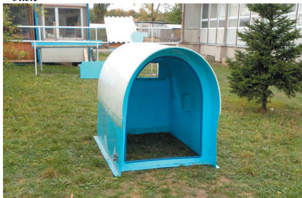
Obr. 2: VIB pokryta 3 vrstvami izolace pod plovoucí podlahy krytých bílým PP plastem, varianta 2
