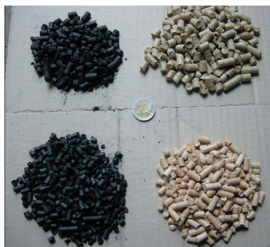
Obr. 2: Pelety dřevních pilin bez kůry a pšeničné slámy průměr 8 mm před a po torefakci
