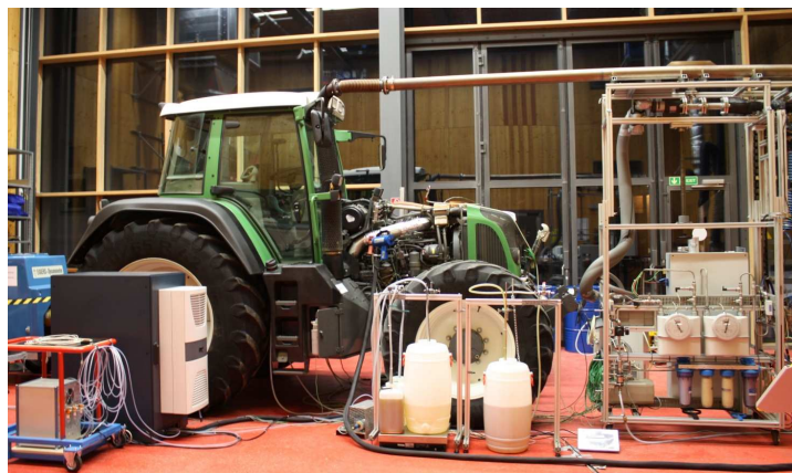
Figure 1: Plant oil compatible tractor at test stand of the Technology and Support Centre (TFZ) Obr. 1: Traktor s pohonem na rostlinný olej na zkušebním zařízení v Technologickém a podpůrném centru (TFZ)
