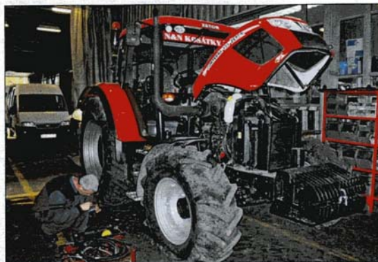
Před měřením byl do traktoru namontován průtokoměr pro měření spotřeby paliva, snímač otáček PTO, pro měření otáček motoru, snímače otáček zadních kol pro stanovení prokluzu a přijímač GPS pro zjištění rychlosti jízdy
