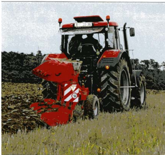
Obr. 4. - Použití orebních těles KV9 s pološroubovými odhrnovačkami znamená vyšší hrudovitost a hřebitost zoraného pozemku, avšak též nižší orební odpor, a tím i nižší energetickou náročnost
