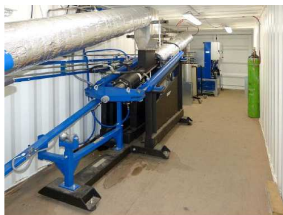
Obr. 22: Pohled na část PS02 Zplyňování technologické zkušební linky s výkonností do 20 \text{ kg}\cdot\text{h}^{-1} vstupní suroviny v PolyComp, a.s. Poděbrady
