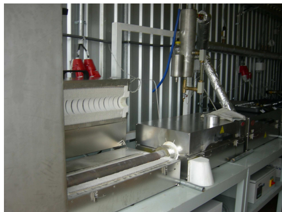
Obr. 20: Pohled na vytápěné sekce trubkového reaktoru se šnekovnicí vývojové zkušební linky dvoustupňové termolýzy s výkonností do 2 \text{ kg}\cdot\text{h}^{-1} vstupní suroviny v PolyComp, a.s. Poděbrady
