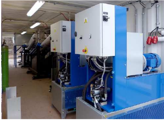
Obr. 23: Hydraulické zařízení pro pohon pístů trubkových reaktorů pro karbonizaci a zplyňování technologické zkušební linky s výkonností do 20 kg.h -1 vstupní suroviny v PolyComp, a.s. Poděbrady
