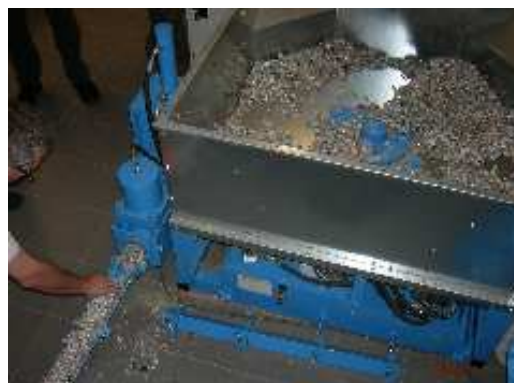
Obr. 26: Zkoušky schopnosti dopravy a lisování TAP - MEVO ve formě fluff
