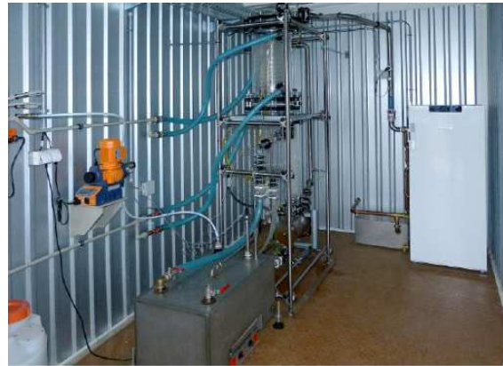
Obr. 24: Pohled na část PS03 Praní surového syntézního plynu technologické zkušební linky s výkonností do 20 kg.h -1 vstupní suroviny v PolyComp, a.s. Poděbrady
