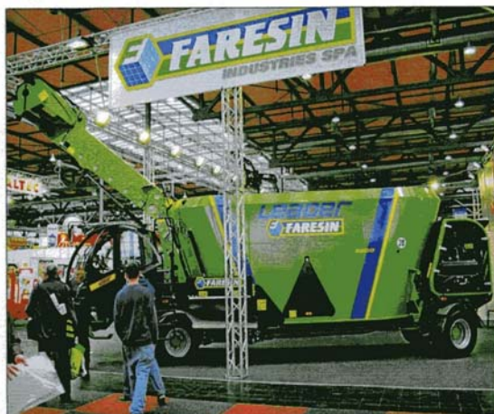
Dvě řiditelné nápravy zlepšují manévrovatelnost. Naproti tomu umístění motoru v zadní části MKV prodlužuje jeho délku a manévrovatelnost zhoršuje. Je proto potřebné velice pečlivě prověřit průjezdné profily stájí a manévrovací prostor kolem stájí a skladů krmiva (poloměry zatáčení, sklon rampy v silážním žlabu ve vztahu ke světélce výšce MKV apod.)
