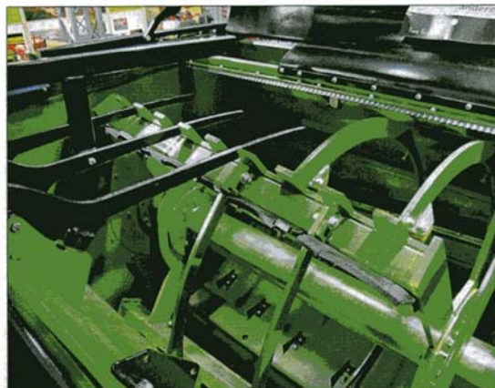
MKV s míchacím hřídelem (pádlem) se vyznačují šetrným zacházením s krmivem. Jsou často vybaveny zařízením umožňujícím zpracování obřích balíků a přidavnými noži pro lepší dělení krmiva s dlouhou řezankou
