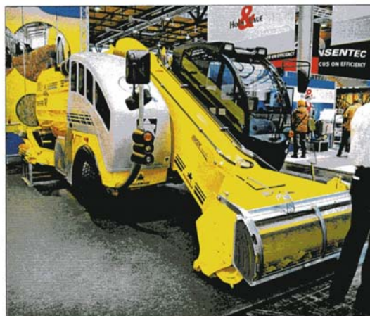
Samojízdné míchací krmné vozy mají mnohdy i libivý design. Umístění motoru v přední části zkracuje celkovou délku MKV a zlepšuje jeho manévrovací schopnosti
