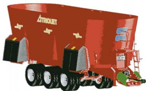
Některé MKV již mají obří vnitřní objem (až 48 m 3 ). Tomu odpovídá mohutně dimenzovaný podvozek
