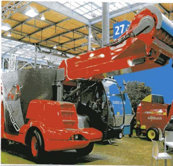
Samojzdné MKV mají často horší manévrovatelnost. Zlepšení přinášejí dvě řiditelné nápravy
