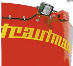
K detailům patří i vybavení MKV reflektorem a snímací kamerou, která umožňuje sledování nakládání krmiva z kabiny traktoru nebo samojízdného MKV.
