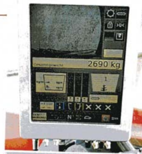
Řízení procesu přípravy krmné dávky a činnosti MKV usnadňují softstikované displeje, které mohou být přenosné a propojené s řídicím počítačem farmy (systém firmy Strautmann)
