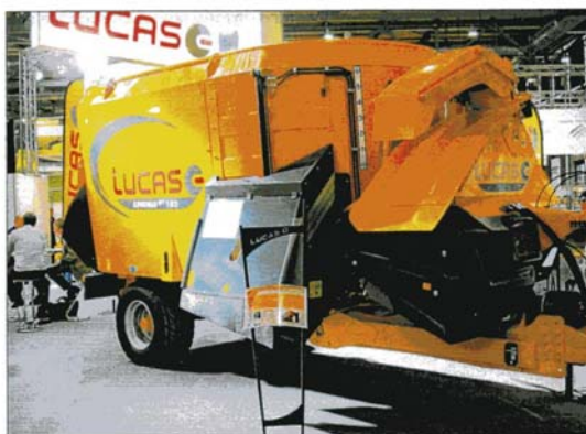
Francouzská firma Lucas vyrábí zajímavě řešený MKV s vertikálními šneky s možností kombinování funkce krmení (vynášeč dopravník a podestýláni (metač)
