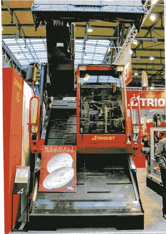
Již delší dobu nabízí firma Trioliet u svých samojzdných MKV oddělování krmiva zařízením s aktivními noži, které se vyznačuje příznivou měrnou spotřebou energie na oddělování krmiva a velmi šetrným zacházením s krmivem
