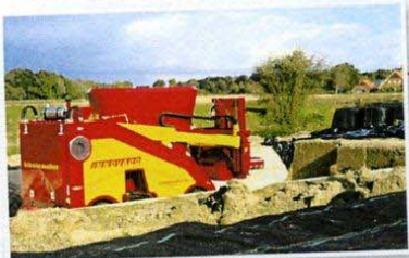
Innovado automaticky zajíždí do silážního žlabu a pomocí odřezávacího rámu uchyceného na otočném rameni odděluje a plní krmivo do korby robotu. Dopravní trasa je řízena senzory, gyroskopem a laserem
