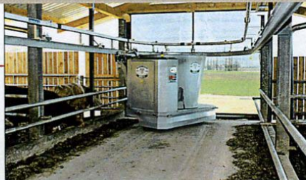
ASK vyráběný rakouskou firmou Wasserbauer je zajímavý tím, že krmicí robot je vybaven vlastním podvozkem a jeho pohyb je řízen vodičí drážkou, která může být relativně subtilní a nevyžaduje mohutné nosné konstrukce. Míchání zajišťuje vertikální šnek a ve spodní části je přehrnovací štít, který při každém krmění současně přehrnuje krmivo. V zobrazeném případě vodičí profil vadí v průjezdu stáji, a proto je možné jeho vyklopení vzhůru v místě průjezdu
