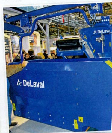
Krmicí robot firmy DeLaval je zavěšen na kolejnici a vyžaduje vestavu nosné konstrukce ve stáji. TMR je připravována ve stacionárním mezizásobníku s vertikálním míchacím šnekem
