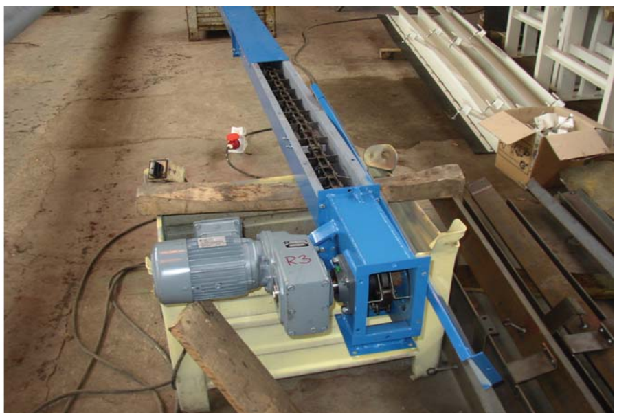
Obr. 2: Řetěz svislého redleru s přerušenými platovými unášeči vlevo, foto konstrukce vodorovného redleru v uzavřené kapse vpravo (ROLLER spol. s r.o.)
