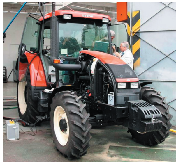
Obr. 2. Zetor Forterra 8641 - měření zrychlení spalovacího motoru
