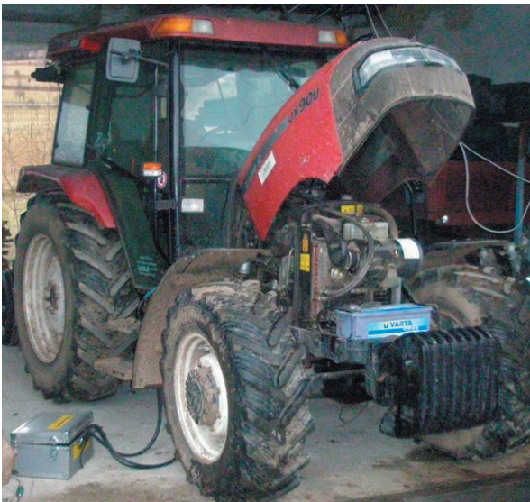
Obr. 1. Case IH JX 90 - měření podélného zrychlení traktoru pomocí GPS
