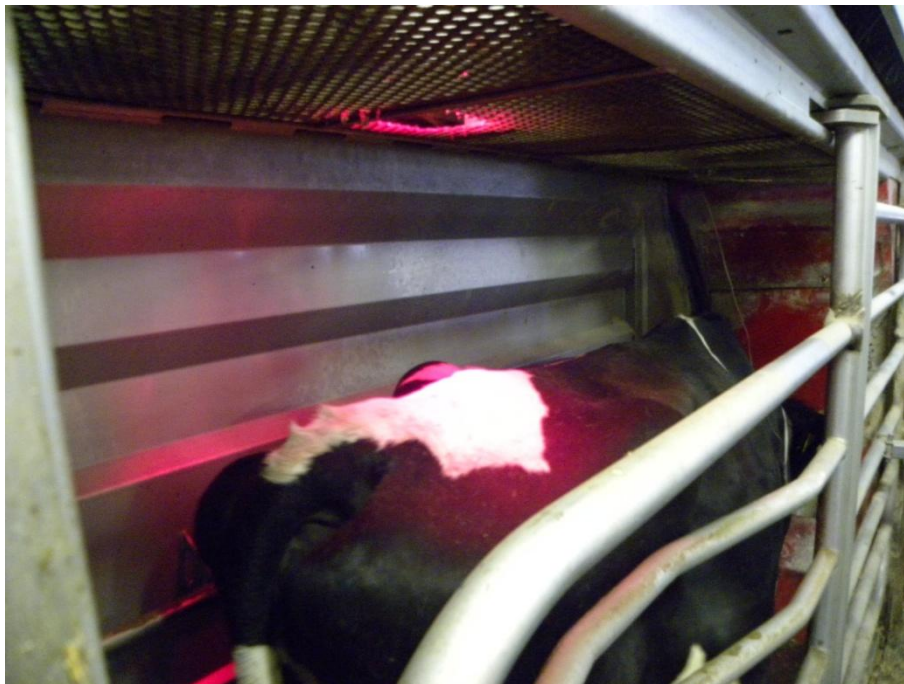
Obr. 2 – Ozařování zádi krávy při dojení infralampou
