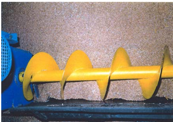
Obr. 1: Detail vyskladňovacího oběžného šnekového dopravníku VŠ-40
