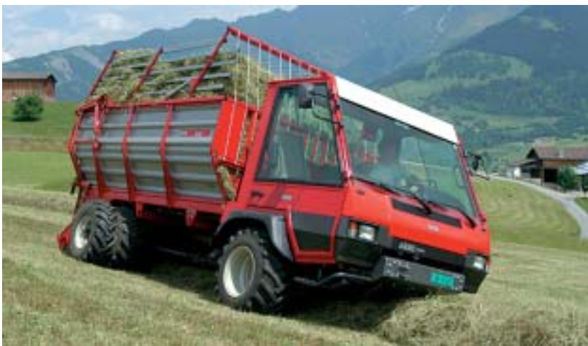
Obr. 4.5 Samojízdný podvozek Transportér AEBI s velkoobjemovou sběrací nástavbou
