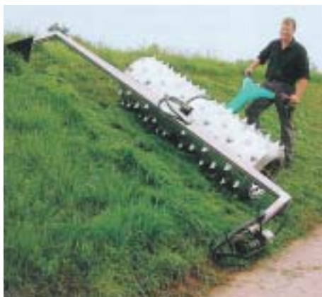
Obr. 4.7 Speciální konstrukce jezdového ústrojí s potiběžnou žací lištou
