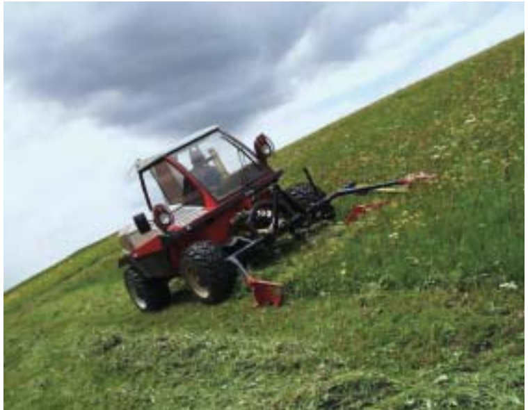
Obr. 4.4 Svahový nosič nářadí s čelně nesenou protiběžnou žací lišťou
