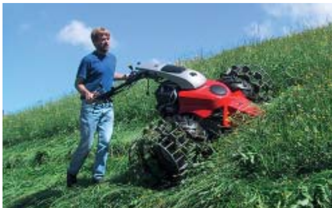
Obr. 4.6 Jednonápravový žací stroj s klecovými koly
