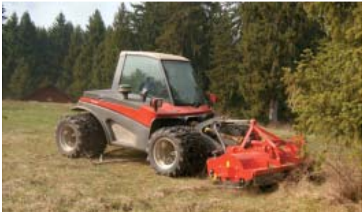
Obr. 3.2 Čelně nesený mulčovač pro likvidaci náletových dřevin
