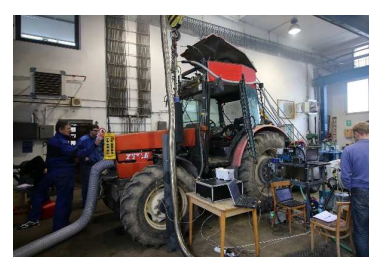
Měření výkonových a emisních parametrů traktoru společně s Centrem vozidel udržitelné mobility ČVUT, fakulta strojní, Praha a TÜV SÜD Roztoky u Prahy. Emisní třída traktoru ZETOR 10540 STUPEN I.
