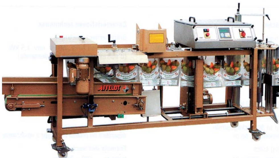
Obr. 24: Pytlovací balící automat do polyetylenové perforované fólie
