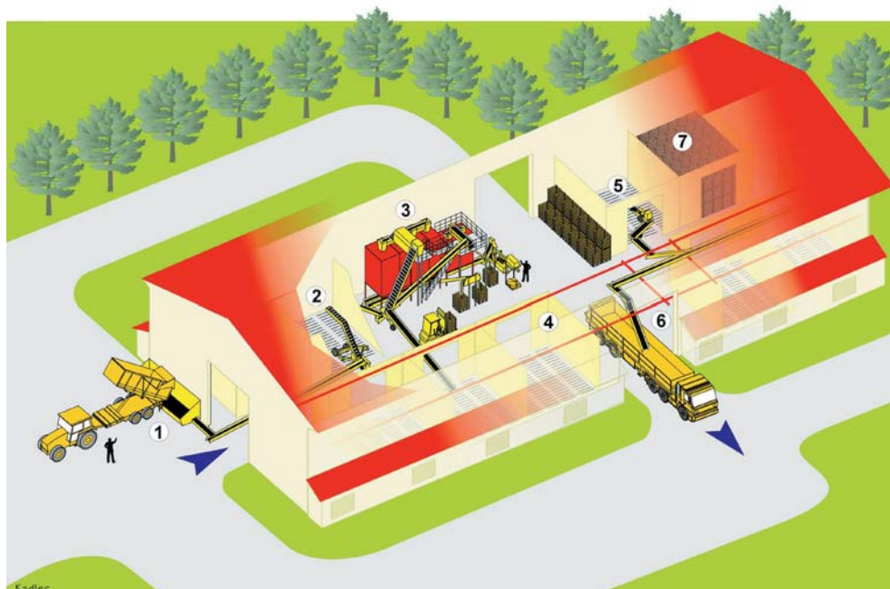
Obr. 18: Schéma nových provedení skladů brambor a technologií naskladňování, úpravy a vyskladňování brambor
