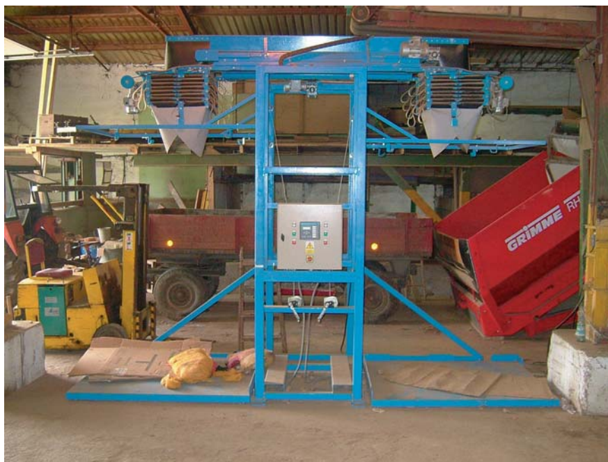
Obr. 22: Automatický plnič vaků Bluetech Pacov s. r. o.
