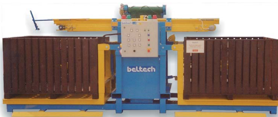
Obr. 20: Plnič ohradových palet (firma Bluetech Pacov s. r. o., ČR)
