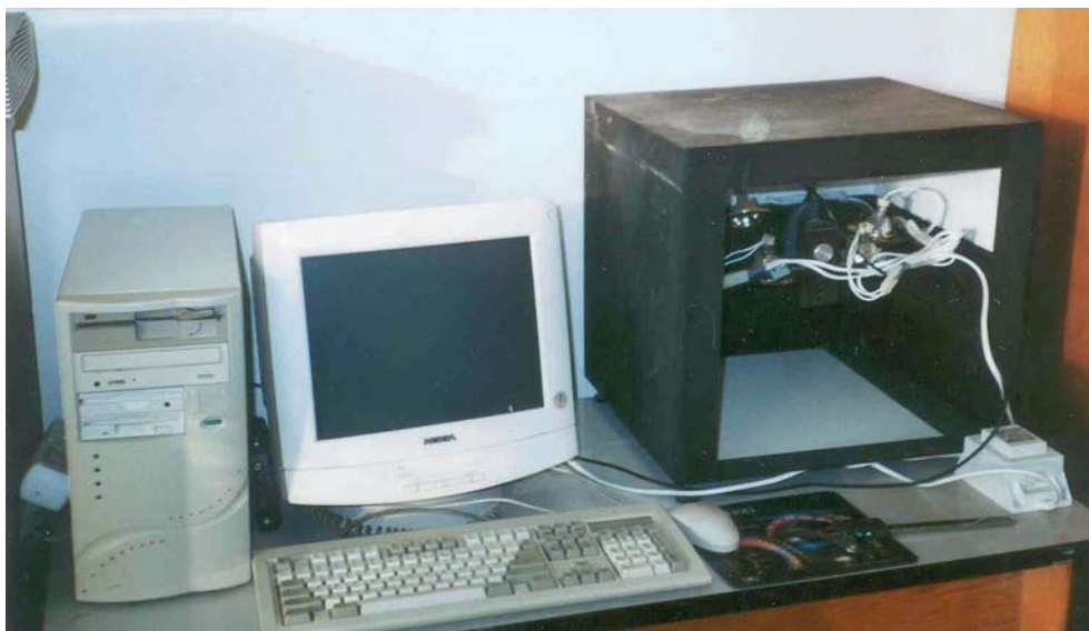
Obr. 43: Měřicí aparatura pro počítačové vyhodnocování barevných změn dužniny hlíz po poškození vlivem mechanického zatížení
