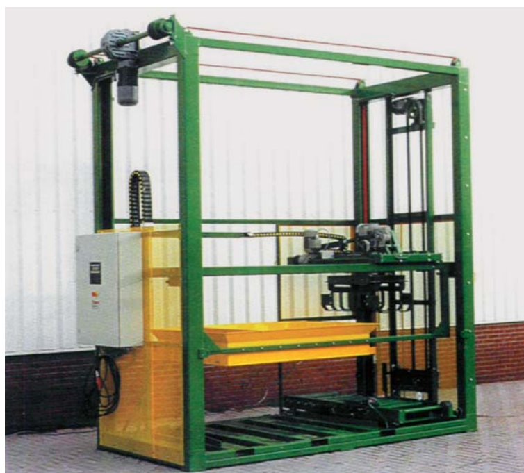
Obr. 25: Automatické paletizační zařízení pro ukládání pytlů na prosté palety
