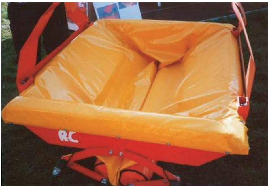
Obr. 48: Úpravy násypek, zásobníků a přepadů v linkách jsou možné tlumícím obložením pomocí zachytávacích gumových, plastových pásů aj. materiálů
