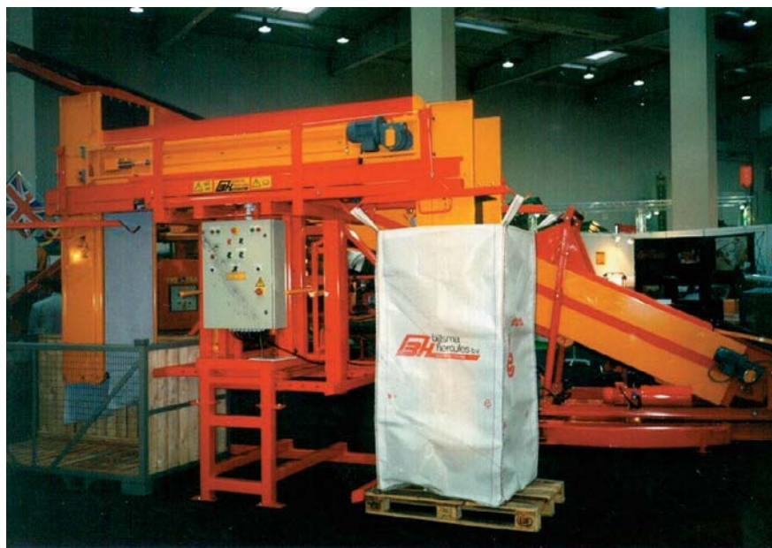
Obr. 21: Kombinovaný plnič ohradových palet a přepravních vaků na brambory (Bijlsma Hercules – Holandsko)
