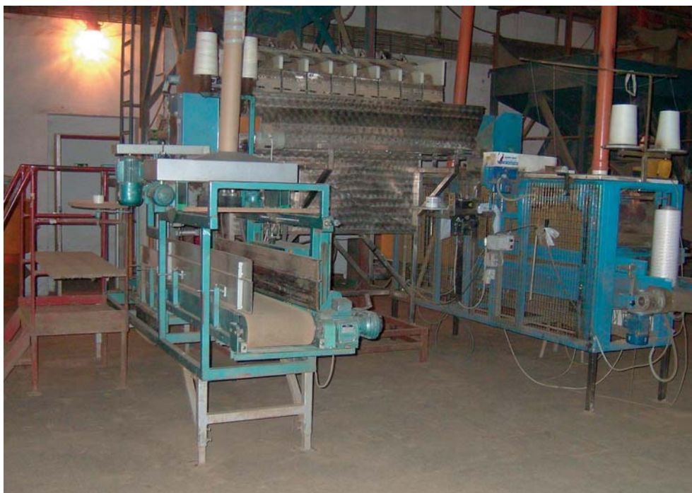
Obr. 23: Pytlovací automatická balící zařízení plněná počítačově řízenými váhami jsou bezobslužná a výkonná
