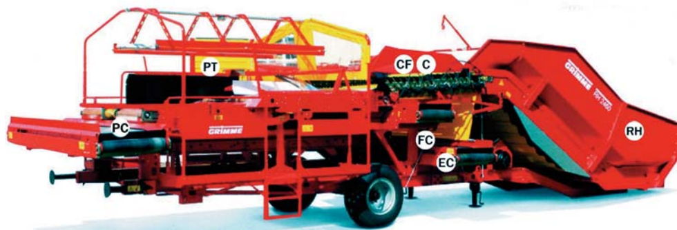
Obr. 17: Nejčastější inovace a rekonstrukce technologicky zastaralých skladů brambor u nás jsou výhodně prováděny pomocí mobilních příjmových a třídících zařízení různých výrobců (RH – příjmový zásobník, C – odhliňovač, CF – frakcionér, EC – dopravník odhliňovače, FC – dopravník frakcionéru, PT – přebírací stůl, WG – pásový třídič, PC – výstupní dopravník)
