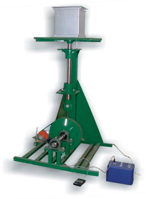
Obr. 42: Zkušební stolice pro testování vzorků hlíz na poškození mechanickým zatížením
