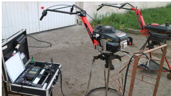
Obr. 3: Měření emisí při volnoběžných otáčkách bez zátěže
