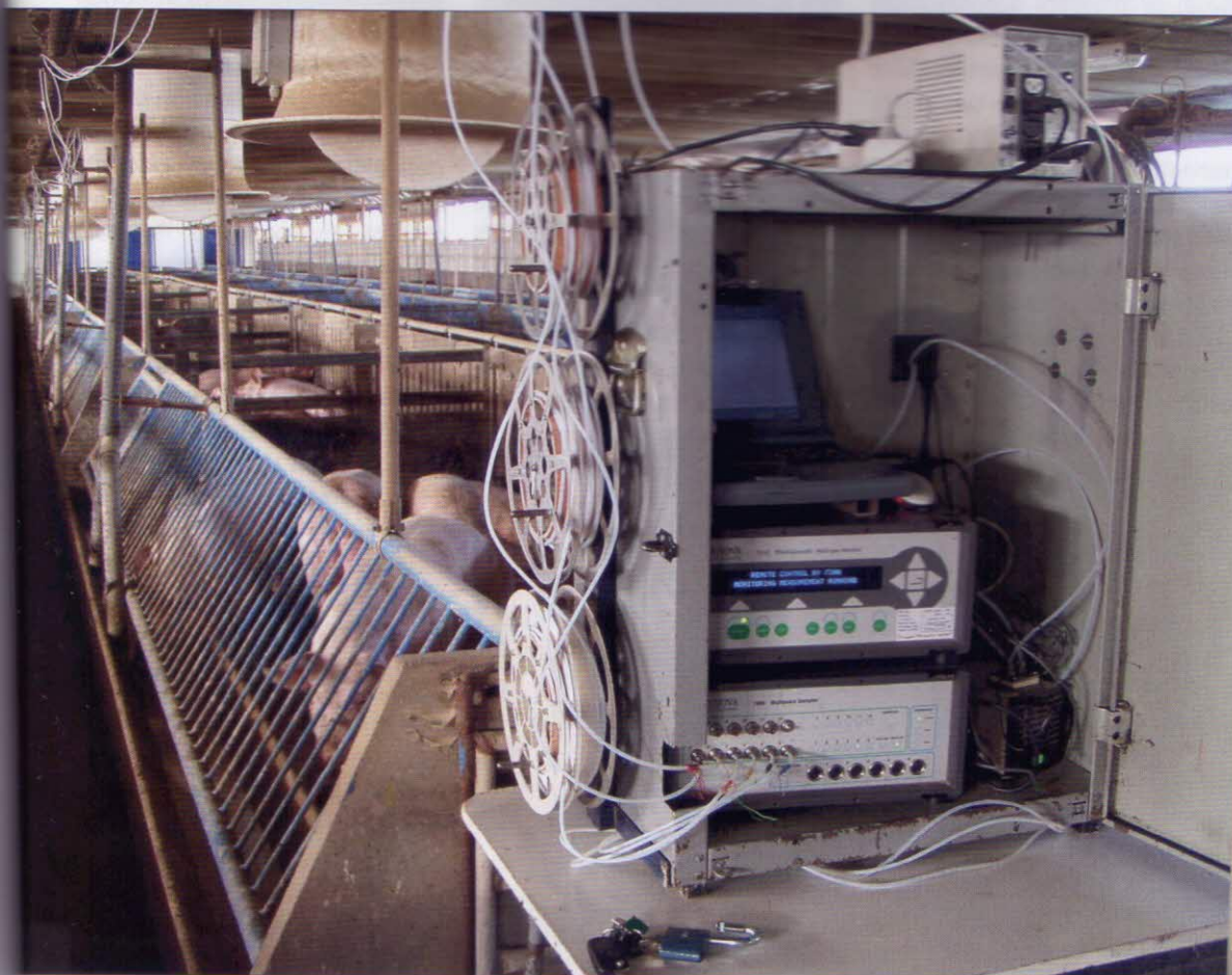
Obr. 2 – Sestava pro měření koncentrací plynů v hale pro chov prasat
