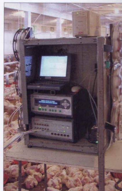
Obr. 1 – Analyzátor s přepínačem odběrových míst při měření v hale pro chov brojlerů
