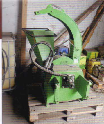
Jemná dezintegrace – štěpkovač Farmi Forest WOOD CHIPPER model 100, energetický zdroj – vývodový hřídel nosiče nářadí AVANT 528. Výkonnost 0,5 – 2 m 3 /h, max. průměr zpracovávané suroviny 100 mm
