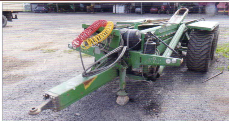
Svoz surovin – traktorový nosič kontejnerů WTC Písečná PORTÝR 14T, nosnost 14 t, celková povolená hmotnost nosiče 20 t, přepravní rychlost 40 km/h
