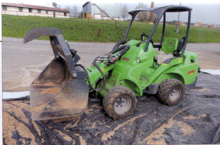
Manipulace se surovinami – kompaktní kloubový nakladač AVANT 528 s dieselovým motorem KUBOTA D722 (výkon 28 kW), objem čelní lopaty 0,33 m 3
