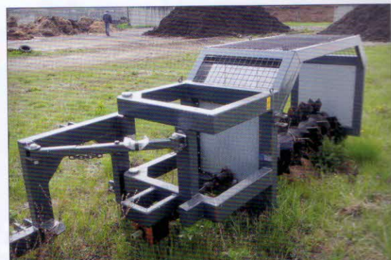
Překopávání kompostu – překopávač kompostu AVP220, energetický zdroj – kolový traktor New Holland T5.95. Pracovní prostor (š x v) – (2,2 x 1,3) m, výkonnost 30 m 3 /h (podle fyzikálních vlastností zpracovávaných surovin)
