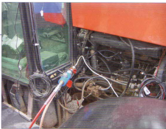
Obr. 9 – Plnění (bio) CNG do traktoru
