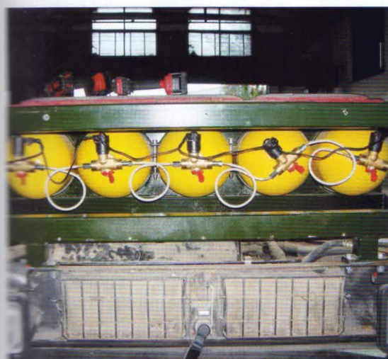
Obr. 5a – Pohled zepředu na tlakové lahve s elektromagnetickými ventily
