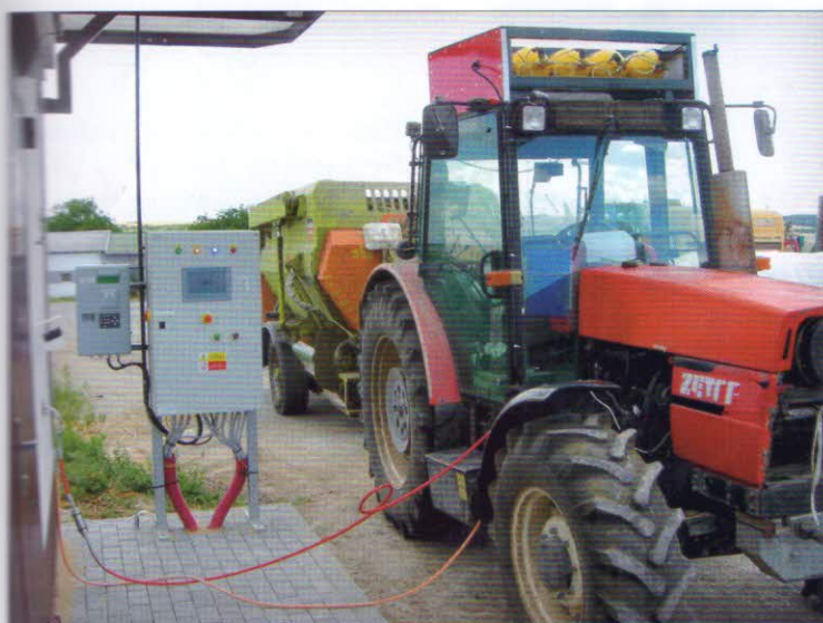
Obr. 2 – Plnění traktoru Zetor 10540 DUÁL stlačeným plynem
