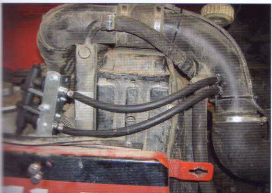
Obr. 12 – Vstřikovací jednotky plynu napojené na sací potrubí vzduchu
