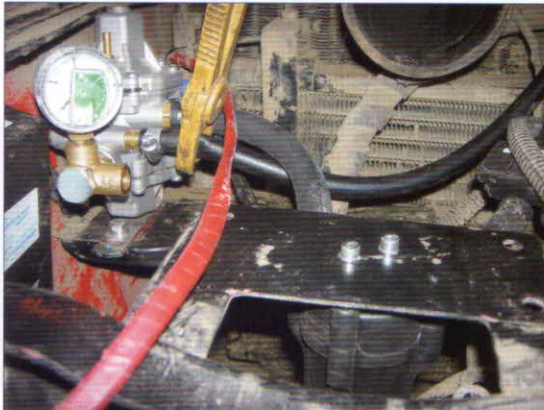
Obr. 11 – Redukční ventil napojený na chladicí okruh traktoru a plynový filtr
