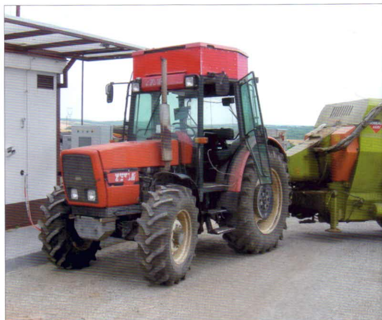
Obr. 1 – Traktor Zetor 10540 DUÁL s michacím krmičím vozem při zajíždění k pilotní plnicí stanici (bio) CNG CG 17
