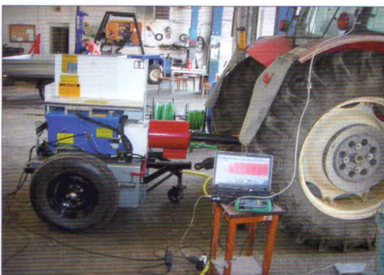
Obr. 13 – Programování řídicí jednotky pro optimální poměr motorová nafta/(bio) CNG pomocí mobilní výkonové brzdě AW NEB 400
