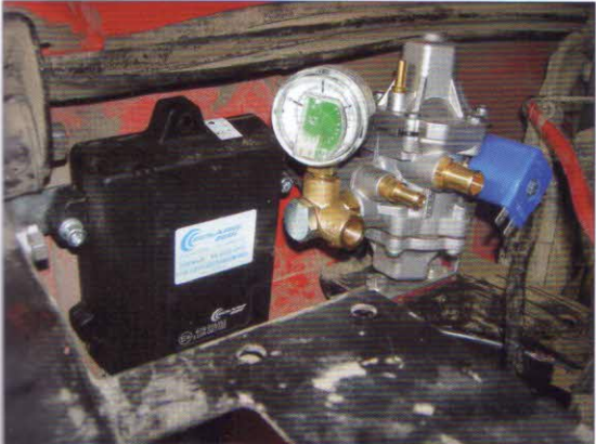
Obr. 10 – Reduktor tlaku plynu, vlevo umístěna řídicí jednotka plynu
