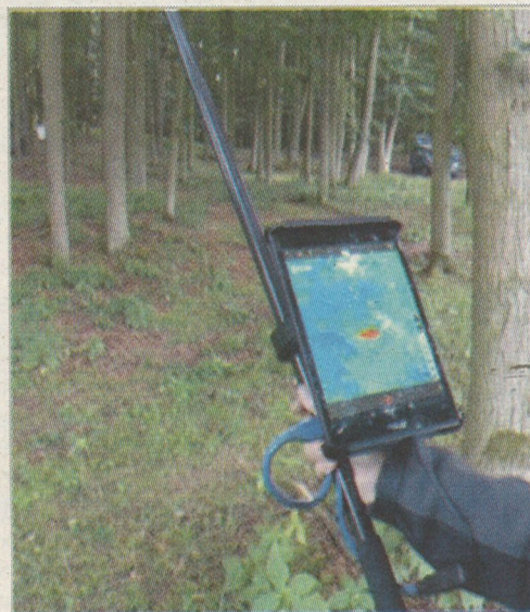
Lokalizace kadáveru divokého prasete pomocí termovizního vyhledávače VMT-VÚZT Foto archiv VÚZT
