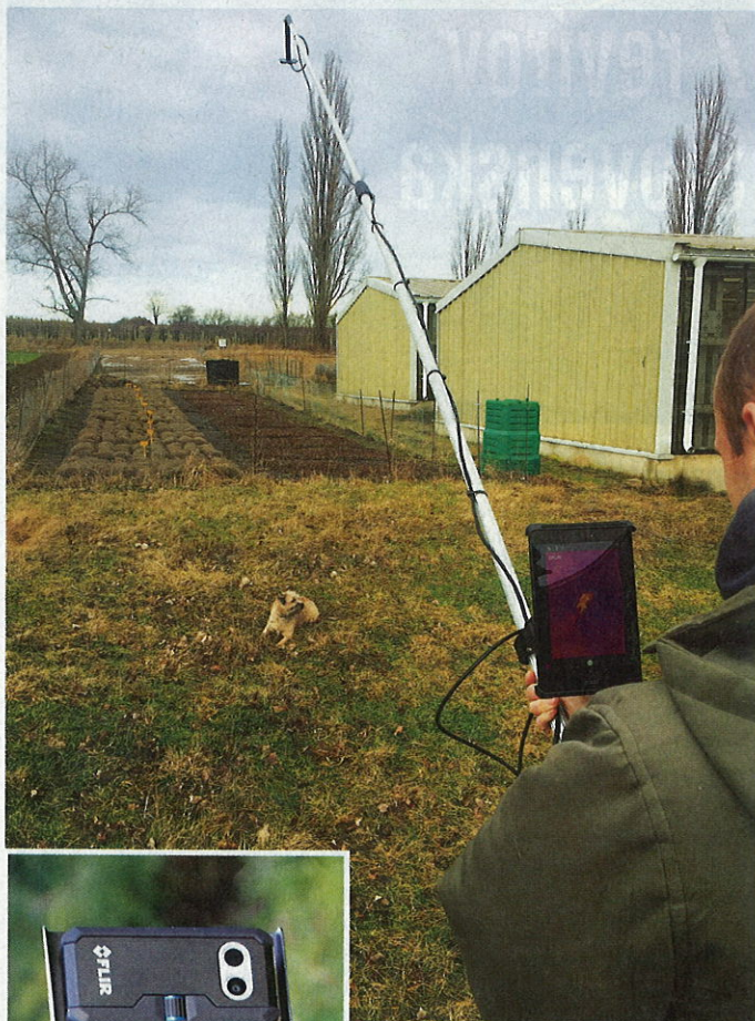
Ověřování vyhledávací tyče VMT – VÚZT s termovizí Flir One
