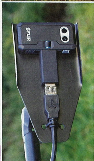
Ověřování vyhledávací tyče VMT – VÚZT s termovizí Flir One
