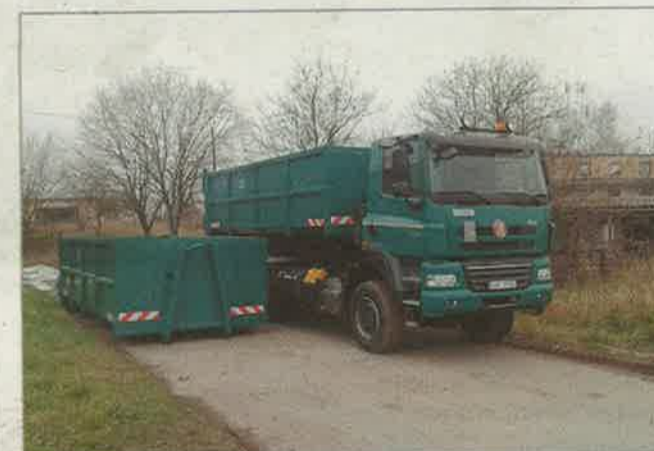
Přeprava surovin a vyrobeného kompostu – svozový nákladní automobil Tatra Phoenix (výkon motoru 340 kW) se zařízením pro nakládání kontejnerů. Kontejnery pro svoz bioodpadu (objem 20 m 3 a 22 m 3 )
