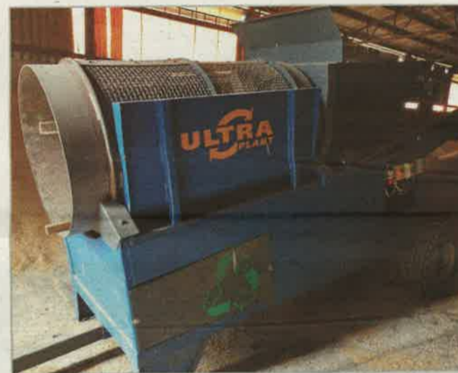
Prosévání kompostu – bubnový síťový třídící Ultra Screen 1000 Mini s elektrickým motorem 6 kW, výkonnost asi 5 t/h
