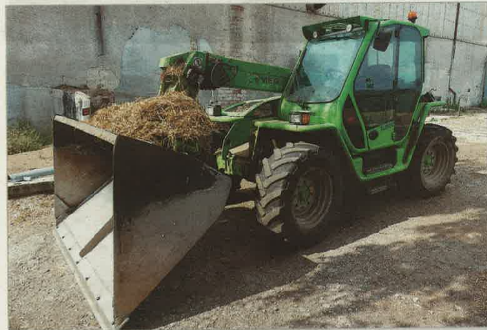
Manipulace se surovinami – manipulátor Merlo s dieselovým motorem 103 kW a objemem čelní lopaty 1,2 m 3
