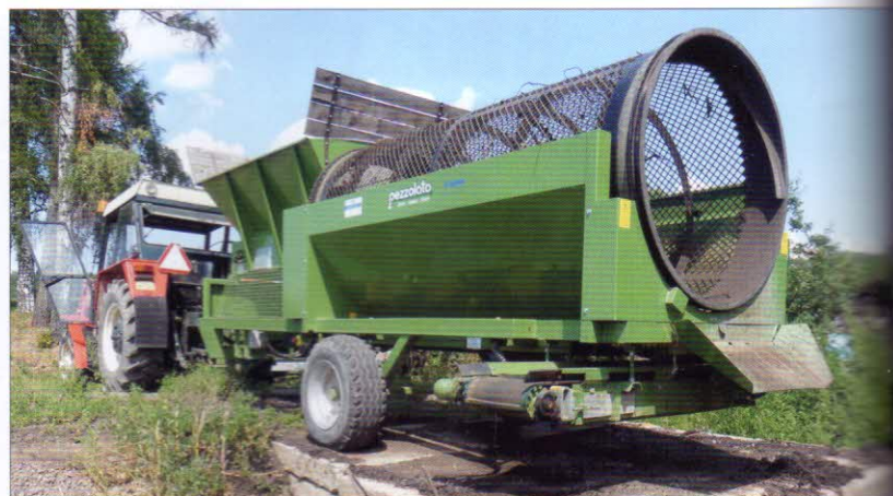
Prosévání kompostu – bubnový třídíč PEZZOLATO typ L 3000 G s kolovým traktorem Zetor 5011. Násypka má kapacitu 3 m 3 , velikost oka síta 25 x 25 mm, výkonnost zhruba 30 m 3 /h závisí na vlastnostech prosévajících surovin
