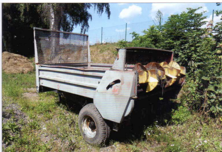
Provzdušňování kompostu – rozmetadlo chlévské mrvy pracuje v agregaci s kolovým traktorem Zetor 5011
