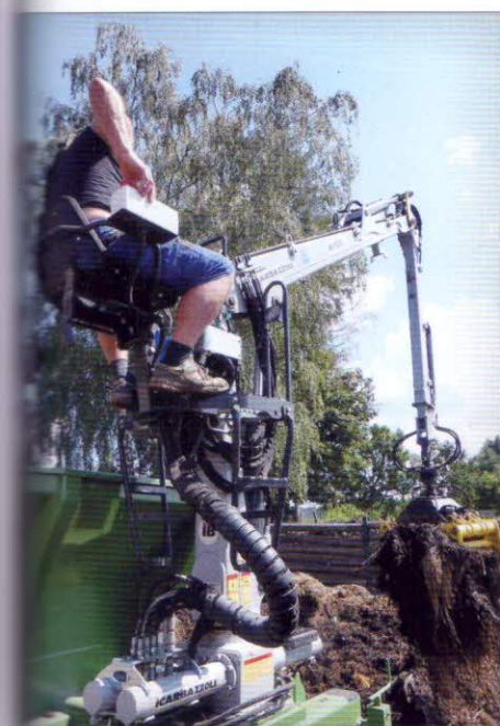
Vkládání bioodpadů do násypky drtiče pomocí hydraulické ruky
