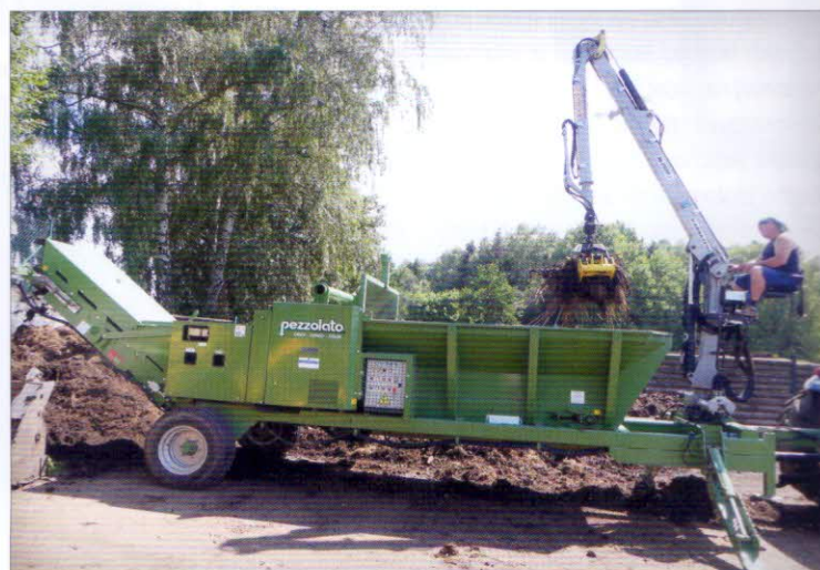
Příprava surovin do základky – drtič dřevní hmoty PEZZOLATO typ S 9000 G v agregaci s kolovým traktorem. Objem pracovního prostoru 3 m 3 , výkonnost 40 m 3 /h (závisí na vlastnostech zpracovávaných surovin)
