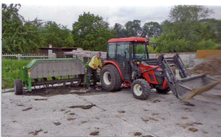
Energetický prostředek a manipulace se surovinami – kolový traktor KIOTI LX 500L s výkonem 36 kW. Čelní nakladač STOLL EcoLine FE 650
