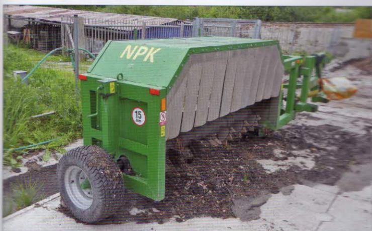
Překopávání kompostu – překopávač kompostu NPK M 230 s pracovním prostorem (š x v) 2000 x 1300 mm
