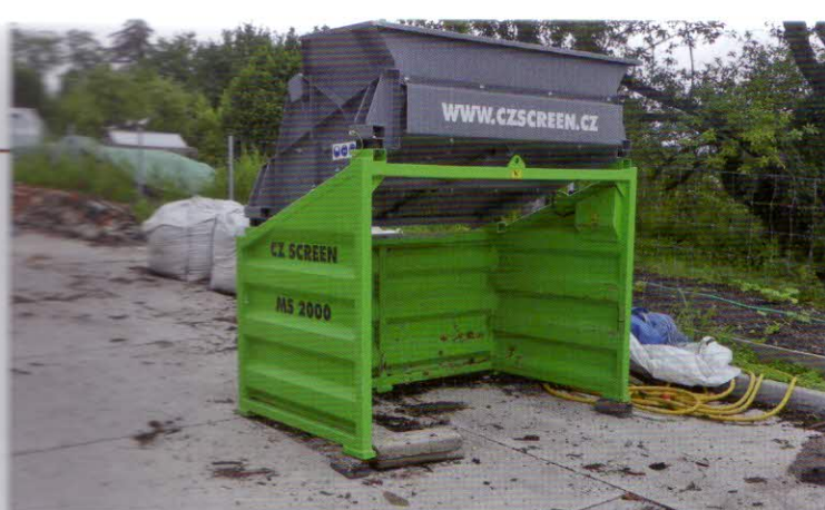
Průsévání kompostu – třídič MS 2000 s elektromotorem (0,55 kW) Výkonnost zhruba 10–20 t/h
