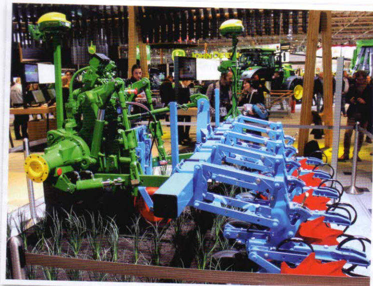
John Deere má v nabídce automatické navádění plečky pomocí řízení polohy ramen tříbodového závěsu
