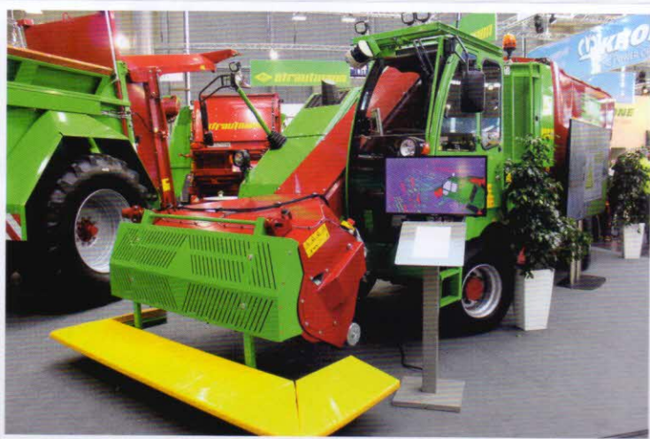
Tento samojízdný krmený vůz Strautmann VertiMix 1701SF používá 3D laserový scanner a umí pracovat zcela bez řidiče
