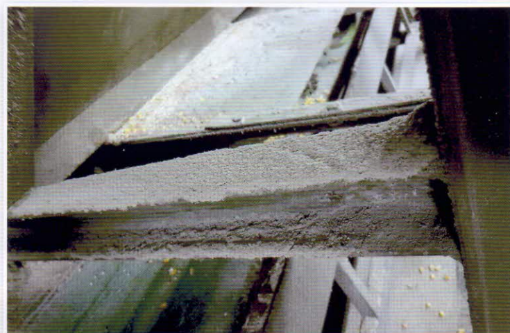
Obr. 4 – Prach obsahující mykotoxiny a spory hub na konstrukčních prvcích příjmového koše umístěných nad pásovým dopravníkem kontaminuje naskladňovanou obilovinu Foto Jiří Bradna
