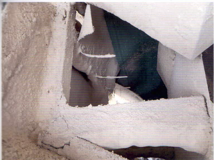
Obr. 6 – Rizikové místo kontaminace naskladňovaných obilovin prachem, obsahujícím mykotoxiny a spory toxigenních hub – přechod mezi pásovými dopravníky Foto Jiří Bradna
