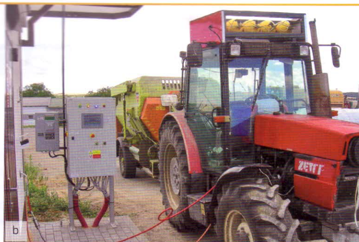
Na duální provoz (nafta/CNG) byl upraven traktor Zetor 10540 (a – před úpravou, b – traktor po úpravě čerpá CNG z nové stanice)
