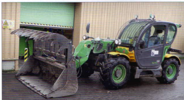
Manipulace se surovinami – manipulátor DIECI 185 (74 kW) s lopatou (1 m 3 ) a vidlemi (výška zdvihu 7,8 m)
