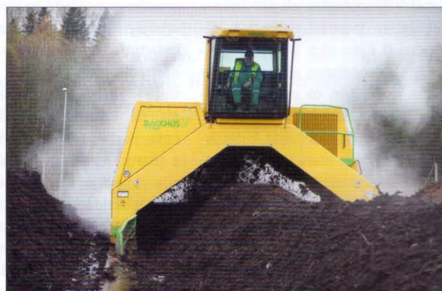
Překopávání kompostu - samojízdný překopávač kompostu BACKHUS 17,50 s dieselovým motorem (209 kW), pracovním prostorem (š x v) 4,4 x 2,2 m a výkonností 3600 m 2 /h. Je vybaven zavlažovacím adaptérem
