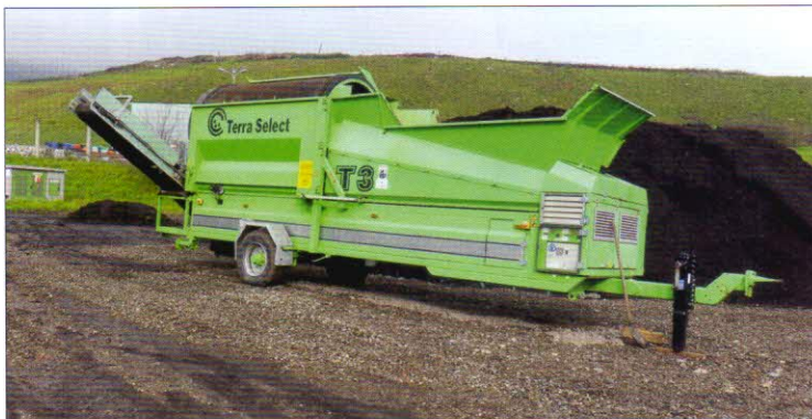
Prosévání kompostu – bubnový třídící Terra Select T3 s třídícím výkonem do 60 m 3 /h (velikost oka síta 24 nebo 40 mm)
