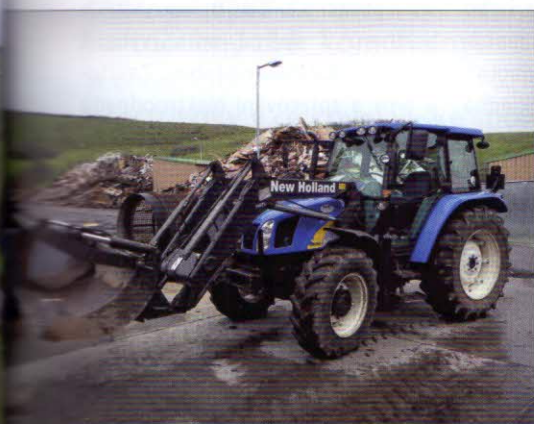
Energetický prostředek – kolový traktor New Holland T5050 s výkonem 71 kW a čelní nakládací kombinace vidle – lopata
