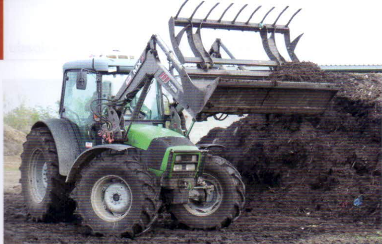
Energetický prostředek + manipulace se surovinami – kolový traktor DEUTZ-FAHR 14P s výkonem 70 kW. Je vybaven čelním nakladačem (vidle, lopata) MAILLEUX MX U 308
