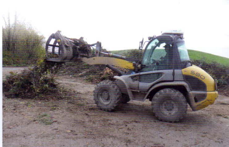
Manipulace se surovinami – univerzální nakladač Kramer Allrad 580 s dieselovým motorem o výkonu 56 kW. Lopata s přidržovačem má objem 0,95–1,50 m 3
