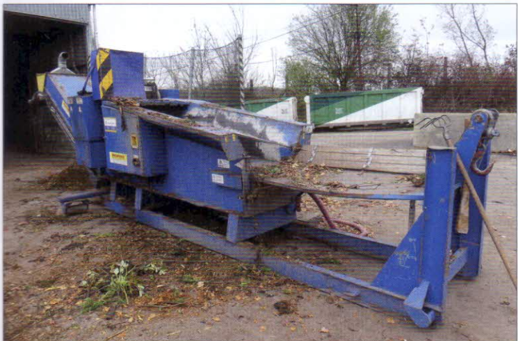
Jemná dezintegrace – elektrický drtič HUSMANN HFG II s elektromotorem 46 kW. Maximální průměr zpracovávané suroviny 150 mm, dodrcovací síto s oky 120 x 120 cm
