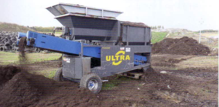
Prosévání kompostu – bubnový síťový třídíč ULTRA SCREEN 1000 s dieselovým motorem 6 kW. Výkonnost zhruba 5 t/h
