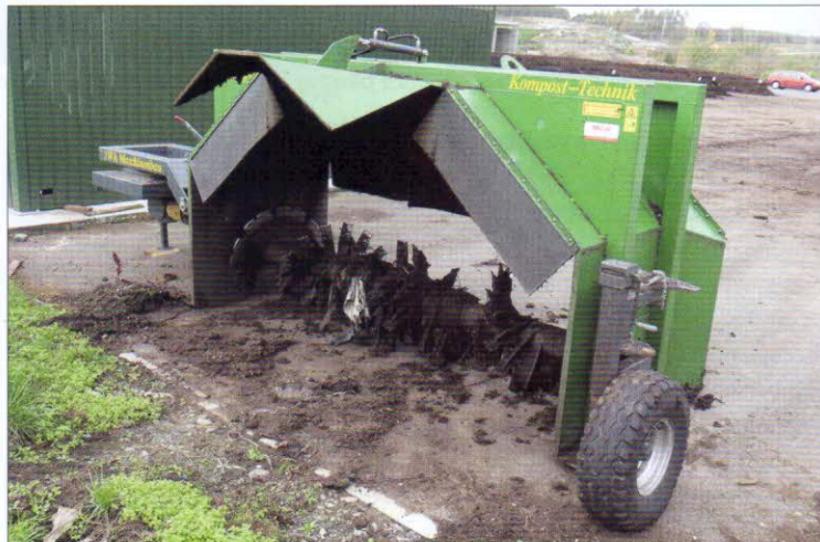
Překopávání kompostu – překopávač kompostu MORAWETZ US 3000 v agregaci s kolovým traktorem. Pracovní prostor (š x v) 3000 x 1500 mm. Speciální vybavení – sklopení pro transport, adaptér pro svinování kompostovací plachty
