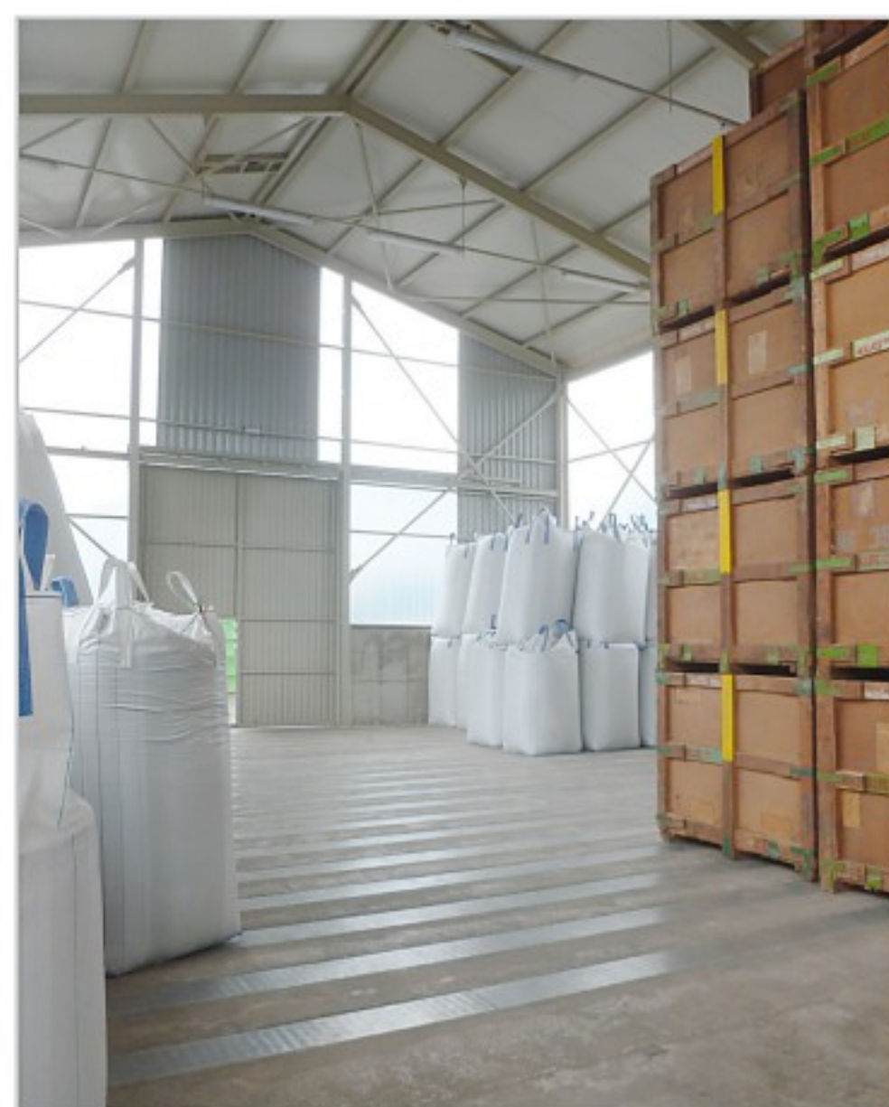
Skladování osiva v halovém skladu s technologií provzdušňování podúrovňovými kanály Foto archiv společnosti AGROING BRNO s. r. o.
