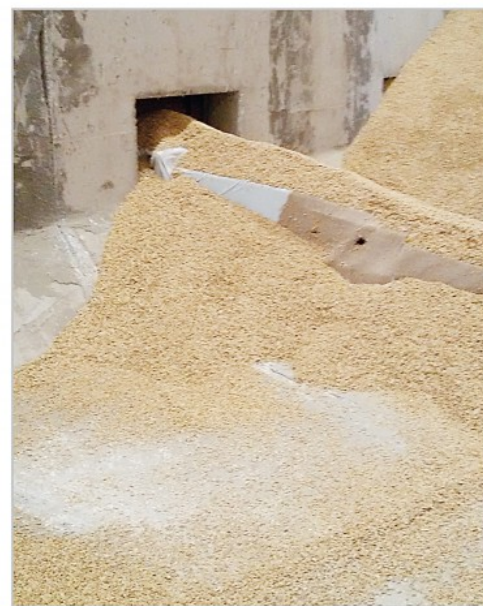
Napojení radiálního ventilátoru na mobilní klecový provzdušňovací kanál Foto archiv autorů článku
